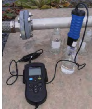
Figure 3.6 : Montage de la sonde à oxygène dissous et de l'enregistreur Hach pour la mesure du TUO
