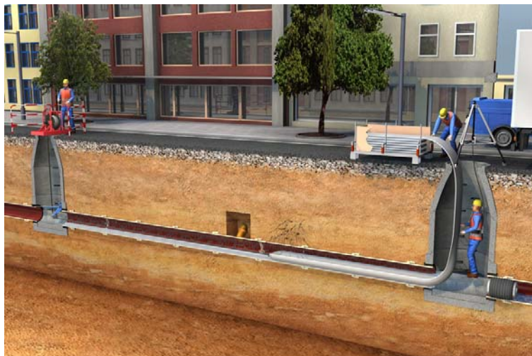
Figure 18 – Insertion de la gaine dans la conduite à réhabiliter (Source : BKP Berolina)
