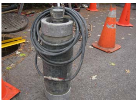
Figure 13 – Exemple de ballon utilisé pour effectuer le blocage des conduites amont
