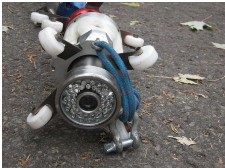
Figure 24 – Caméra à l'avant du train de lumières UV permettant l'inspection avant la cure
