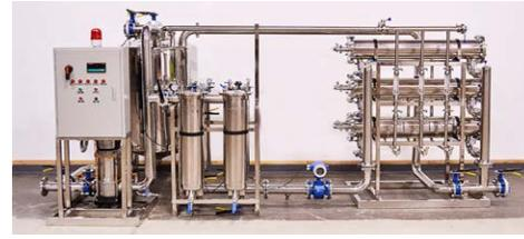
Système de filtration d'échelle pilote. Source : Synder Filtration [synderfiltration.com](http://synderfiltration.com)
