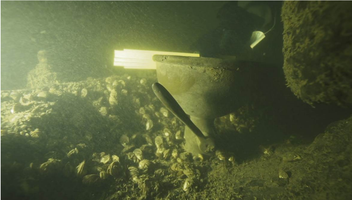
Figure 9 : Entonnoir permettant la lubrification du piston
