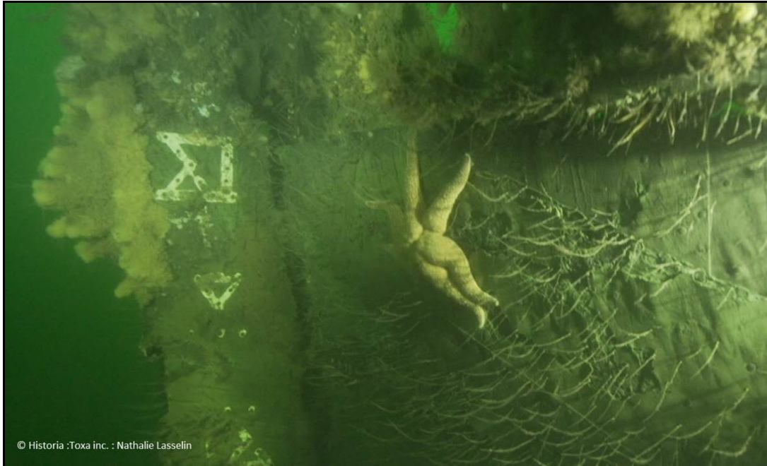
Figure 26 : Exemple de marque de tirant d'eau sur l'étrave
