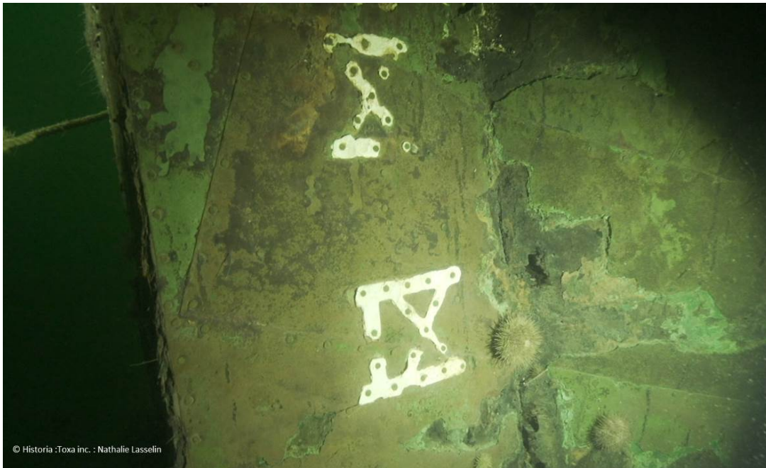
Figure 26 : Exemple de marque de tirant d'eau sur l'étrave
