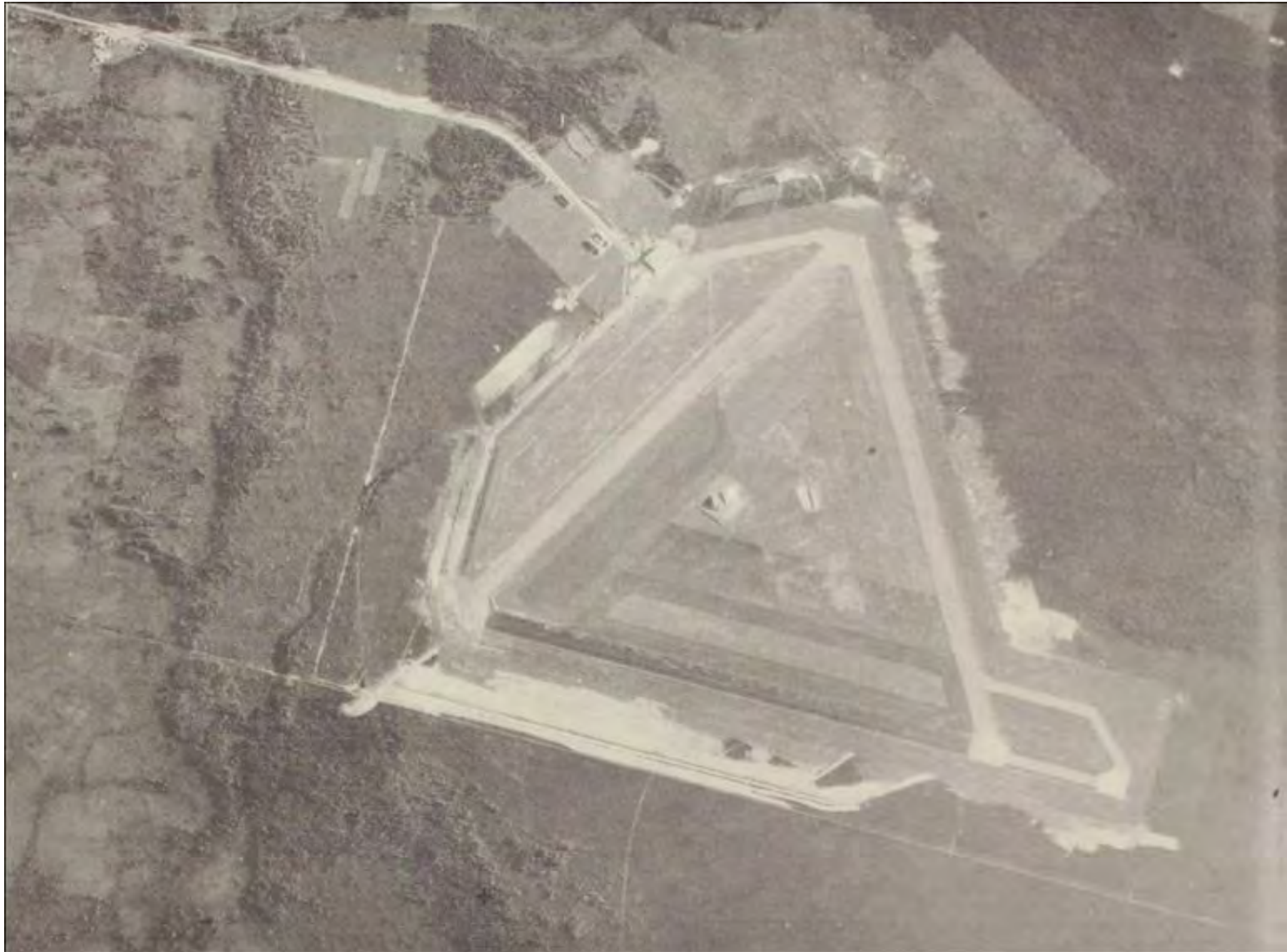
Figure 26 : Vue aérienne de la station R1 Saint-Honoré, été 1942, arborant le modèle « 60 Degree Runway ». (Source : Musée de la Défense aérienne / BFC Bagotville, Collection Dan McWilliams)
