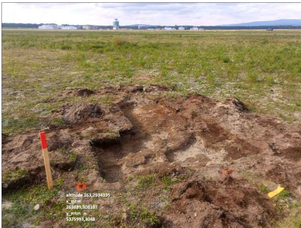
Figure 86 : Étendue de sol congloméré sous la surface du terre-plein, dégagée près de l'anomalie S4-1, vers le nord. (Source : Subarctique Enr., 20200810204908644, 2020-08-10)
