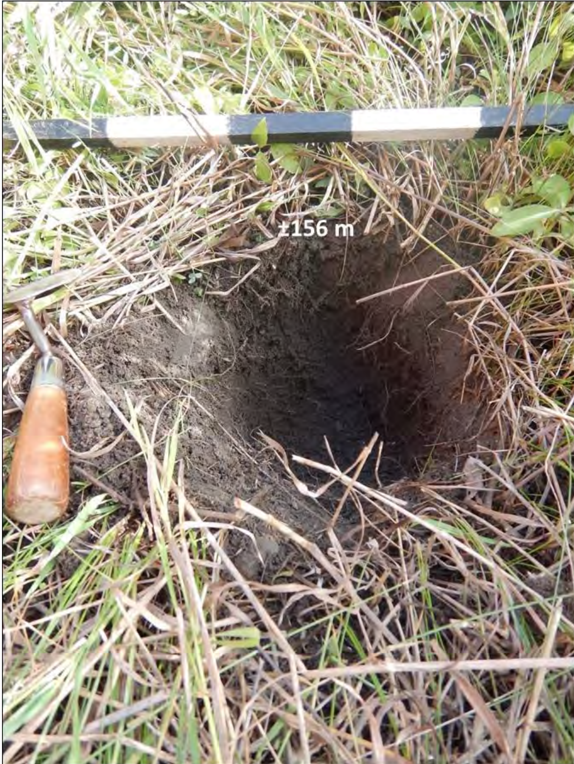
Figure 63 : Détail du sondage EM-02-20 en bordure du fossé où l'on remarque la présence d'un sol humique sous la calotte végétale, vue vers le nord. (Source : Subarctique Enr., DSCN1087, 2020-08-04)
