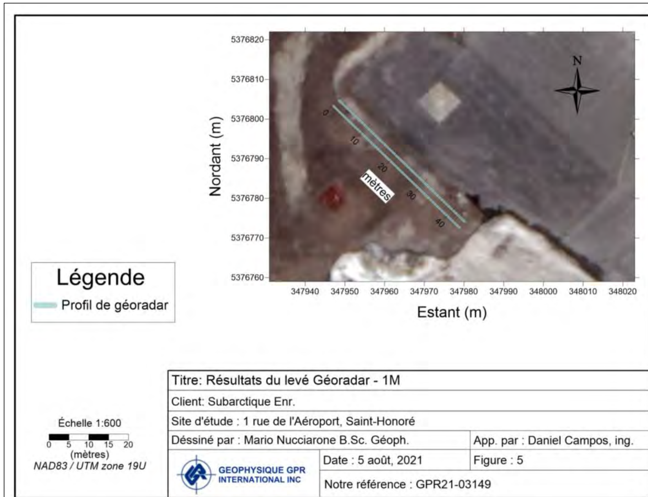
Figure 80 : Levés au géoradar à proximité des infrastructures d'atterrissage des hélicoptères indiquant l'absence d'anomalies. (Source : Géophysique GPR international Inc., août 2021)
