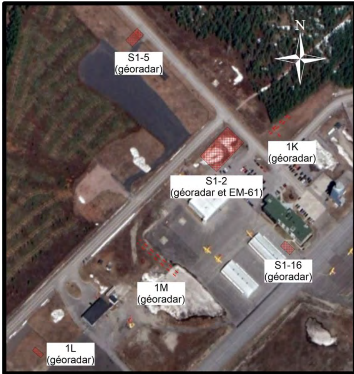
Figure 5 : Photographie aérienne des zones investiguées par géoradar et EM-61. (Source : Géophysique GPR International Inc., « Résultats de levés géophysiques à Saint-Honoré », 12 août 2021, figure 2)
