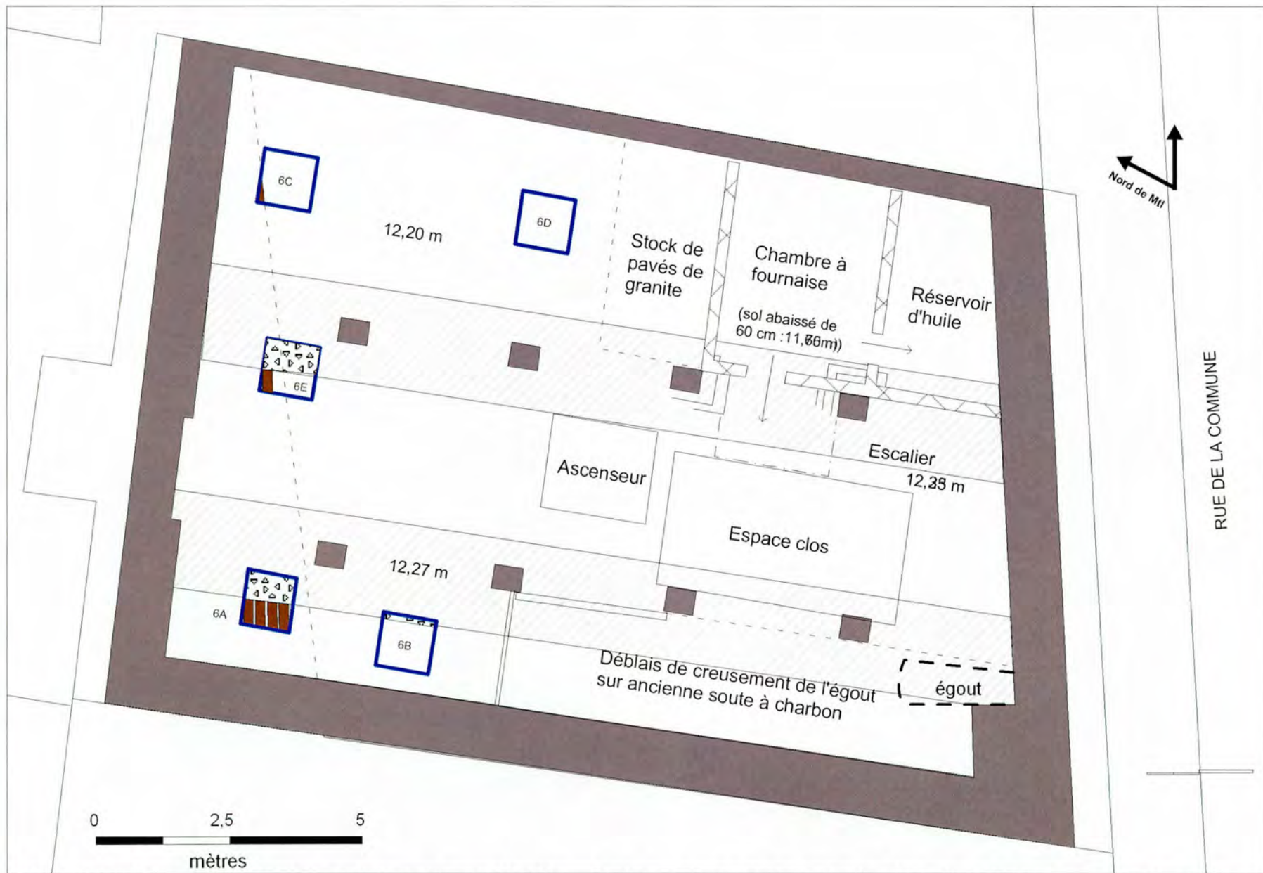
Plan 5 : BfFj-101, opération 6 Bâtiment Robert-Gillespie (1) 211, rue de la Commune ouest - Projection des radiers de béton supportant les piliers
