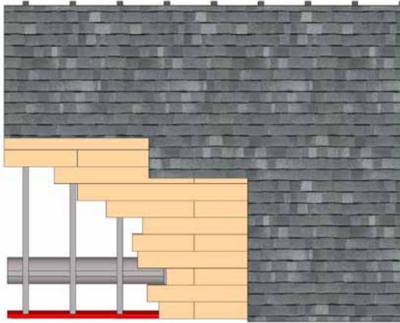
Figure 9 : Situation existante : Les toitures sont constituées d'un platelage de bois en 1'' x 6'' posé sur des chevrons de 2'' x 4'' à tous les 16'' d'entraxe avec un entrain retroussé en 1'' x 6'' tous les 2 chevrons. Le platelage est recouvert de bardeaux d'asphalte trois pattes.
