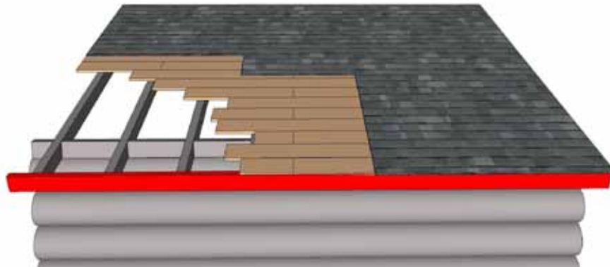
Figure 10 : Situation existante : Les toitures sont constituées d'un platelage de bois en 1'' x 6'' posé sur des chevrons de 2'' x 4'' à tous les 16'' d'entraxe avec un entrain retroussé en 1'' x 6'' tous les 2 chevrons. Le platelage est recouvert de bardeaux d'asphalte trois pattes.
