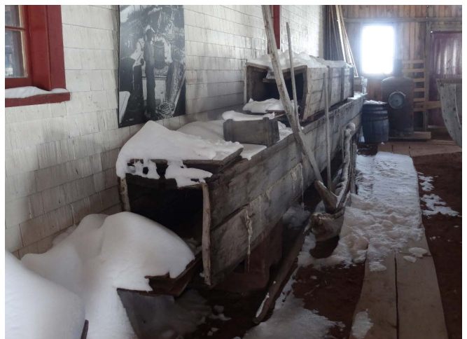
Figure 91 : Des boîtes à vapeur (steam box) utilisées pour courber les pièces de bois sont exposées dans l'appentis.
