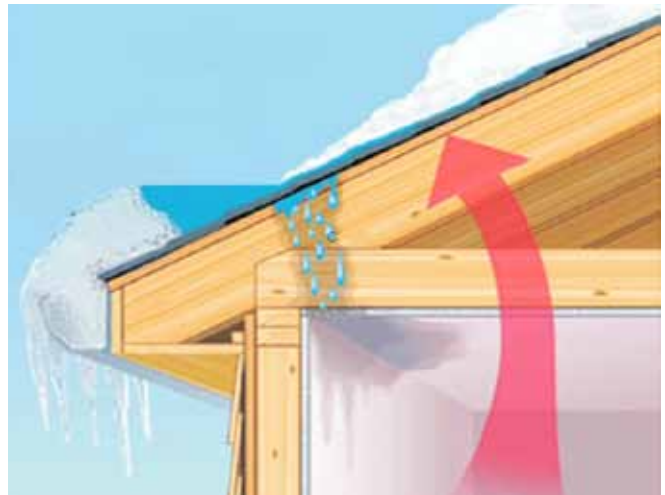
Figure 1 : Formation d'une digue de glace. Source: http://jm.a-007.info/connaissances-sur-les-toitures/digue-de-glace/
