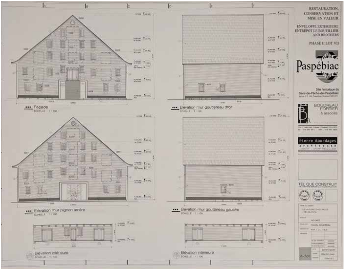
Figure 140 : Restauration de l'entrepôt Le Bottillier en 2004. Boudreau, Fortier et associés.
