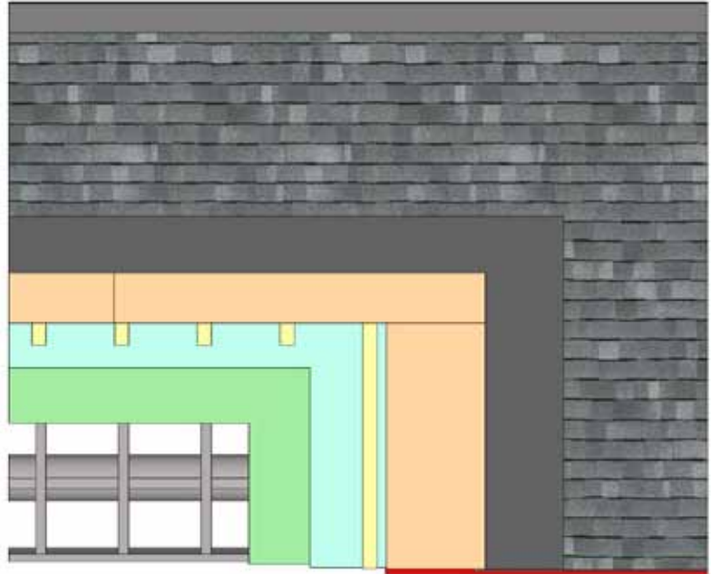
Figure 57 : Situation B : Isolation par l'extérieur.
