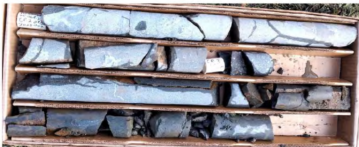
Photo 6. Résultat de l'échantillonnage du roc dans le forage 2Q (MTL23-04-05-2-NUM1-103).
