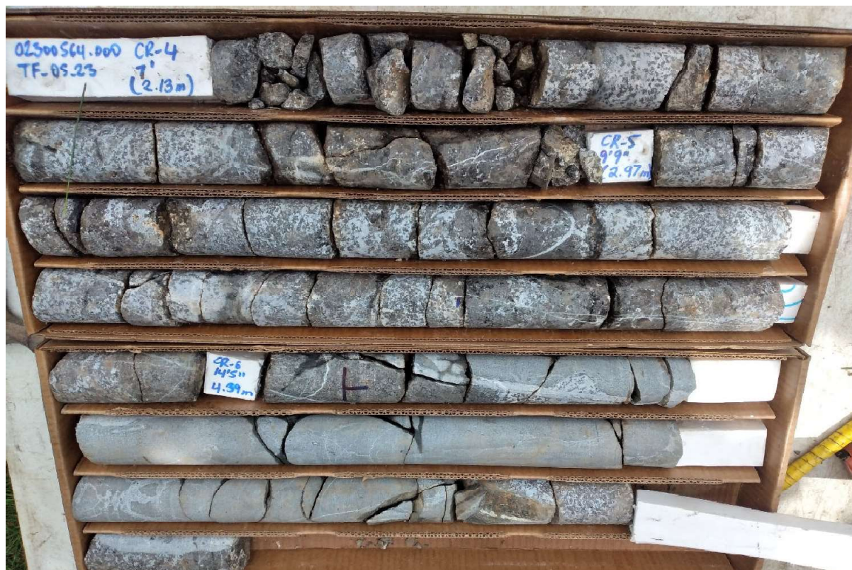
Photo 5. Résultat de l'échantillonnage du roc dans le forage 1E (MTL23-04-05-1-NUM1-29). Trois courses ont été nécessaires afin d'atteindre un roc suffisamment sain pour répondre au seuil nécessaire.
