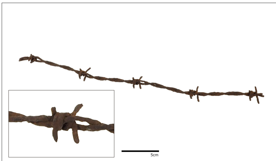
Photo 7.3 5Échantillon d'un fil barbelé composant la clôture du mur de pierres sèches et détail de la pointe Photo Archéotec BOI23_barbele
