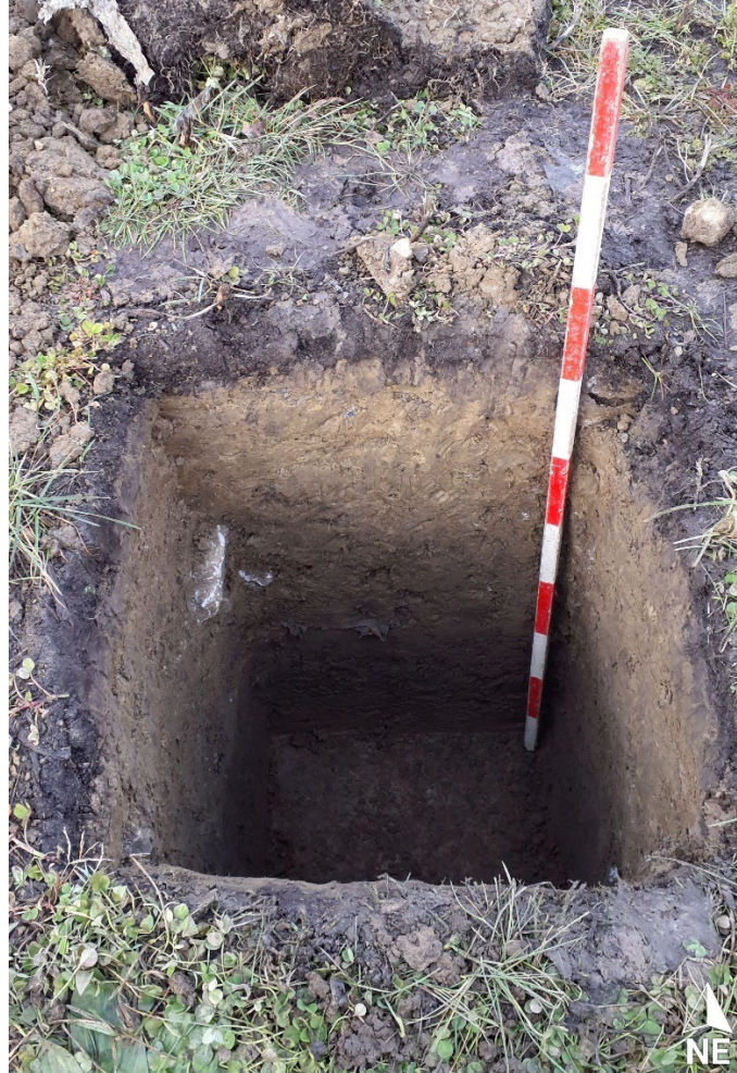
Photo 5. Sondage n° 22 montrant un niveau de sol organique sous la couche de remblai superficiel, vue vers le nord-est (HYD-2328-23-NUM1-31)
