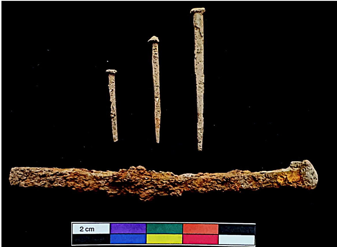
Photo 8 Différentes grandeurs de clous en fer laminé (à noter la forme variée des têtes)
