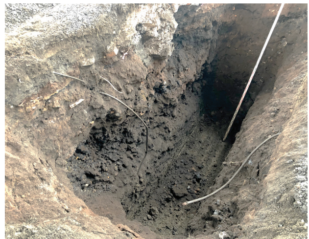
Photo 17 - Tranchée 1D – Paroi sud et niveau atteint – Les remblais recouvrent le sol naturel sur plus de 4,00 m d'épaisseur (MTI22-12-1-22-N1-53)
