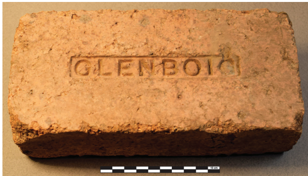
Photo 21 - Brique réfractaire à pâte de couleur saumon portant la marque estampée «GLENBOIG(G)» (ECM-850-1034-2-MTL-22-12-1-1D01-échantillon 1)
