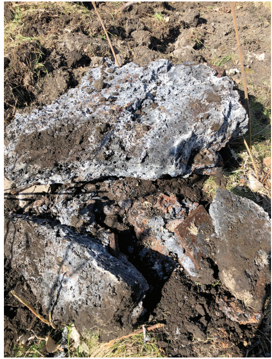
Photo 9 - « Croûte » de pierres amalgamées à des déchets de combustion (MTL22-12-1-22-N1-3)
