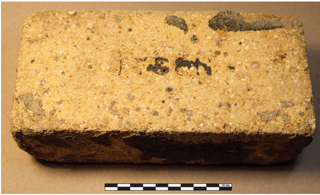
Photo 18 - Fragment de brique réfractaire à pâte jaune portant la marque estampée « Tyson » (ECM-850-1034-2-MTL-22-12-1-1A01-échantillon 2)
