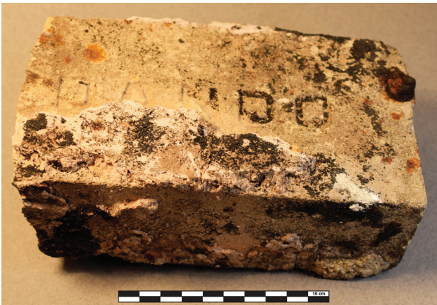
Photo 19 - Fragment de brique réfractaire à pâte chamois-beige portant la marque estampée « Dando » (ECM-850-1034-2-MTL-22-12-1-1A02-échantillon 10)
