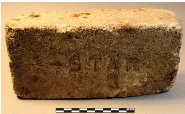
Photo 20 - Brique réfractaire à pâte jaune en forme de prisme trapézoïdal portant la marque estampée « STAR / 3 » (ECM-850-1034-2-MTL-22-12-1-1C1-échantillon 12b)
