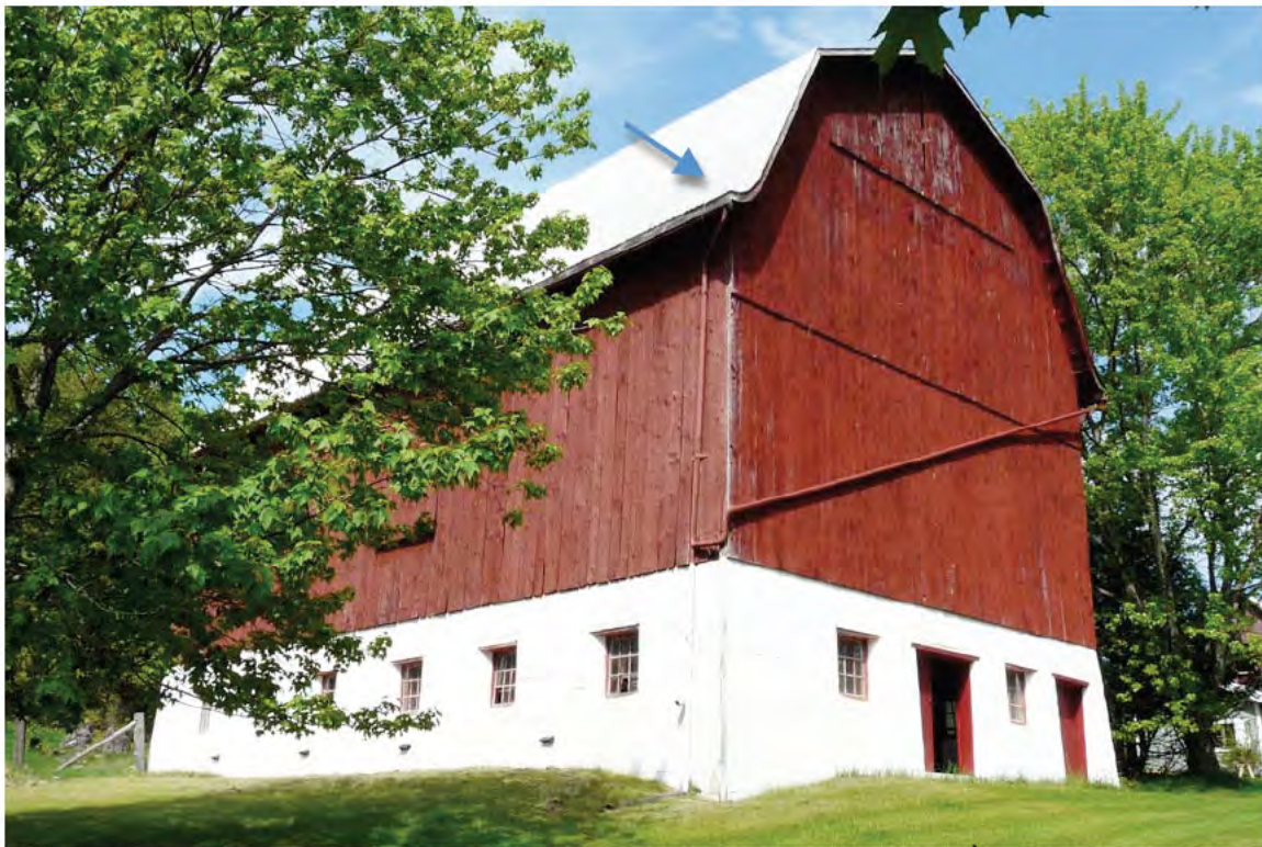
Grange avec étable au rez-de-chaussée typique de la région outaouaise. À remarquer les avant-toits retroussés (flèche) à la base du brisis (partie inférieure de la toiture). P1140758.jpg
