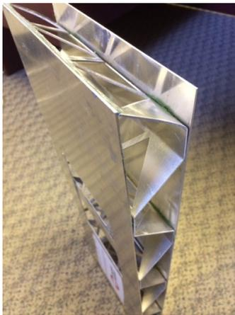
Figure 1 – Panneau structural à âme ouverte
