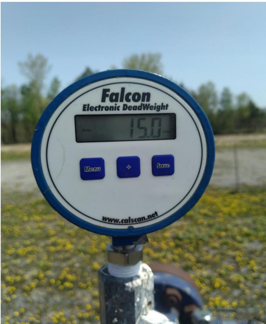
Photo 4 : pression du tube de production (15 Kpa).
