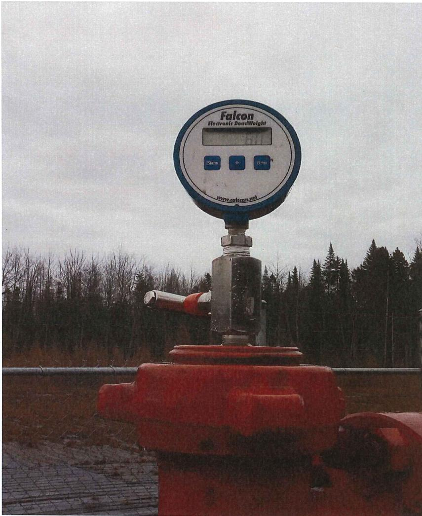
Photo 3 : Pression de 6 kpa au tubage de production
