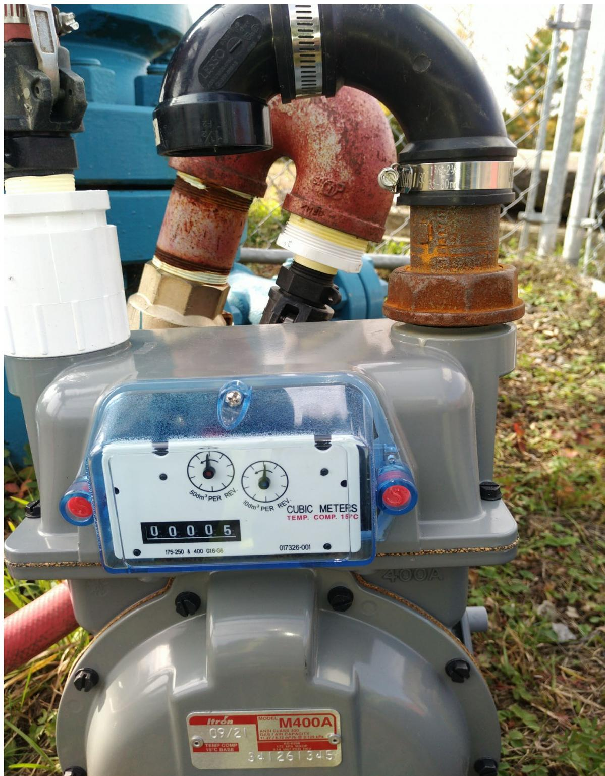
Photo 3 : Débitmètre installé sur 24 heures
