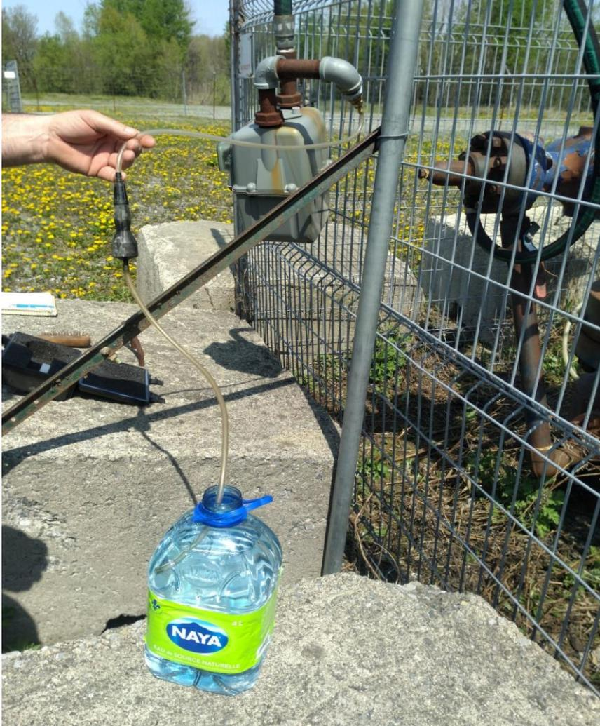
Photo 3 : test de bulle à l'évent du tubage de surface.
