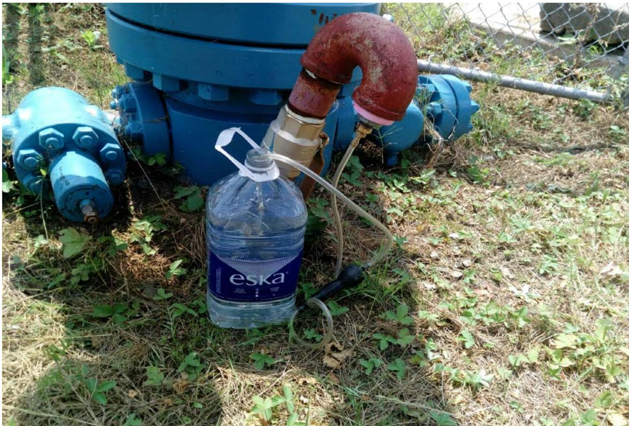
Photo 3 : test de bulle à l'évent du tubage de surface.
