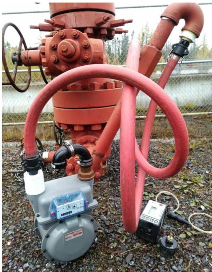
Photo 2 : Installation d'un débitmètre à l'évent du tubage de surface.
