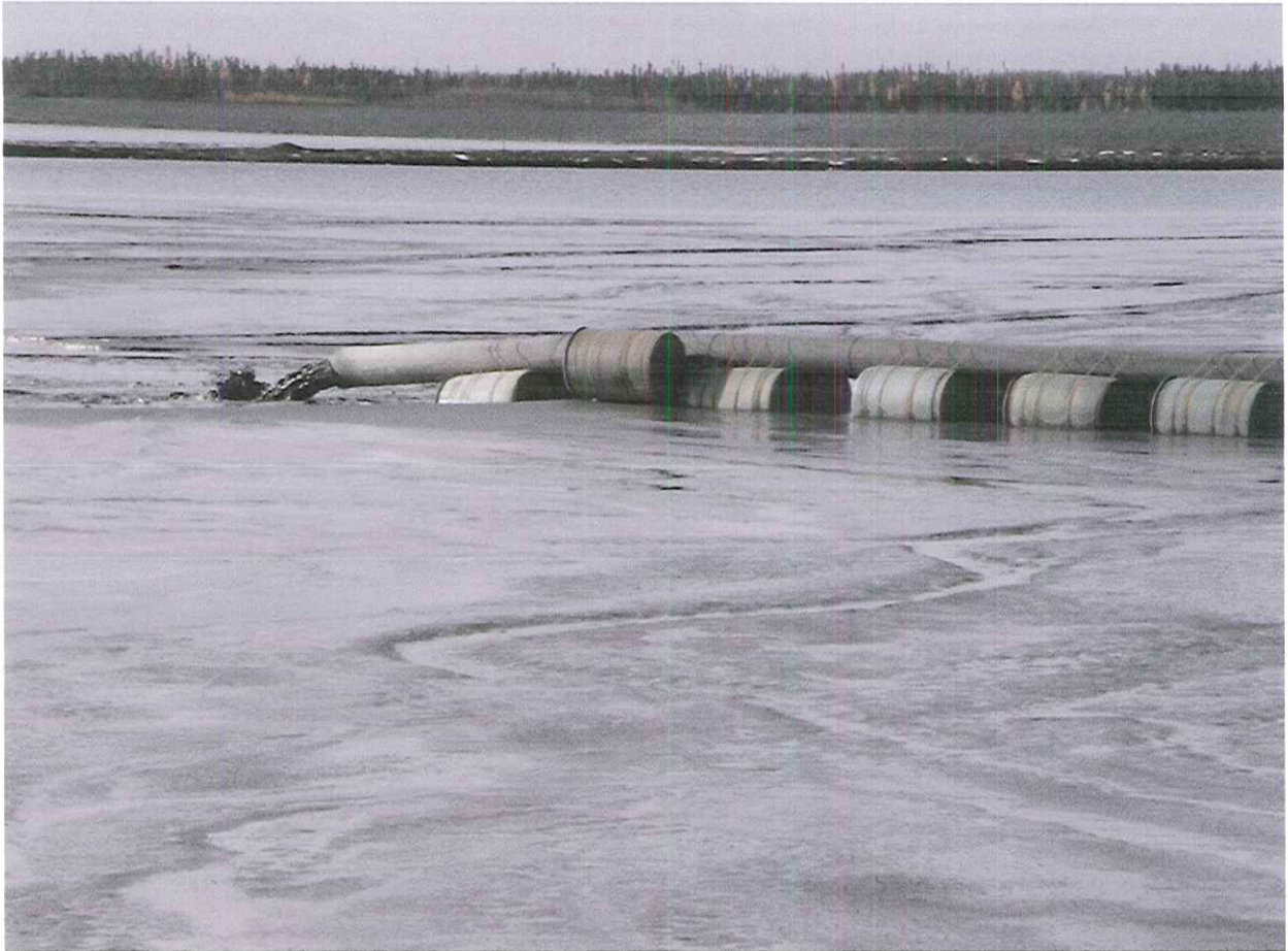
Photo 4 : Décharge des résidus Persévérance au bassin Central.
