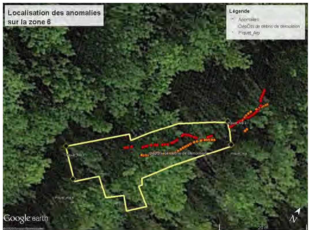
Figure 9 Localisation des anomalies géoradar seules, représentant la partie du sol hétérogène
