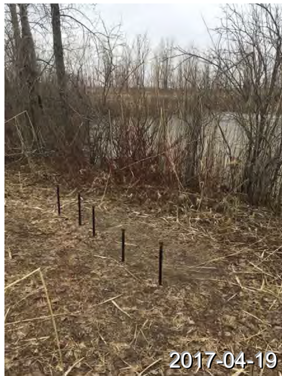
Photo 5 Piézomètres à pointe filtrante installés par Ressources Naturelles Canada à l'automne 2016, au sud-est de l'étang de clarification. Vue en direction ouest.
