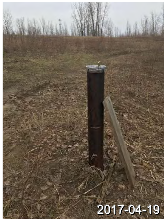
Photo 6 Puits d'observation installé par Niocan en 2011 au sud-est de l'étang de clarification. Vue en direction sud-ouest.
