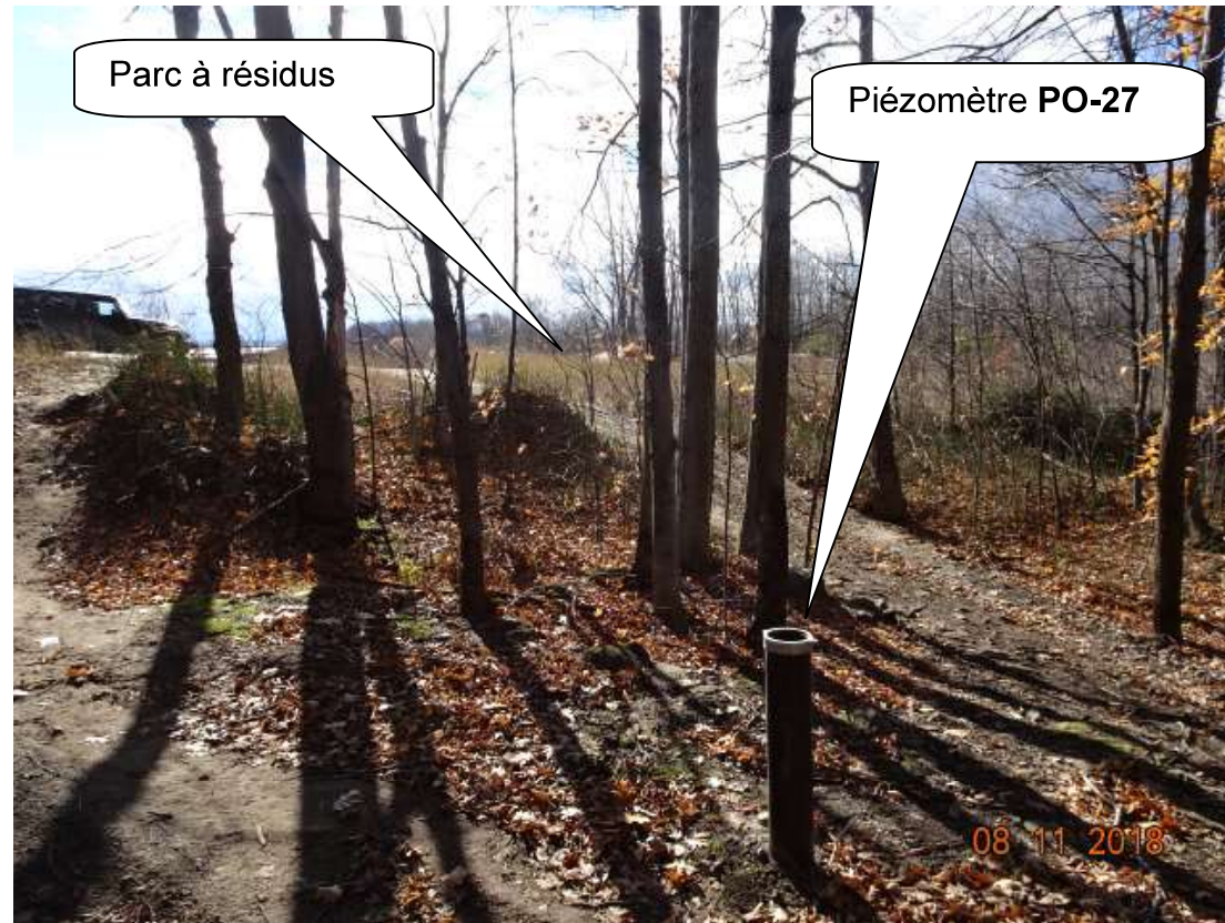
SLC-2018-11-08-015 – Piézomètre PO-027 situé à l'Est du parc à résidus du (vue vers le Sud-Ouest) Coordonnées UTM Nad 83 : 576370 Est, 5039606 Nord
