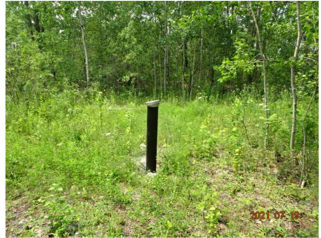
SLC-2021-07-19-007 – Piézomètre 20-F-29 situé au Nord de la fosse 1 (vue vers l'Est) Coordonnées UTM Nad 83 : 575734 Est, 5039332 Nord
