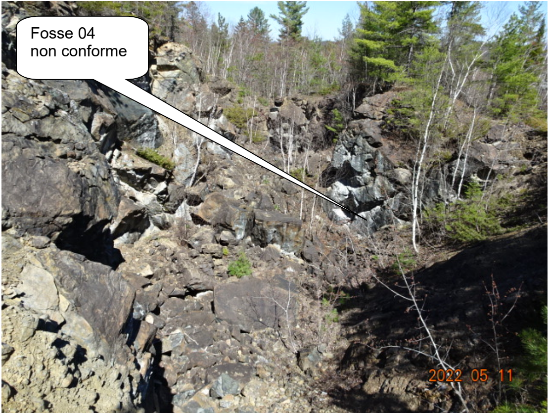
RB-2022-05-11-007 – Fosse 04 non conforme et à sécuriser par remblayage (vue vers l'Est) Coordonnées UTM Nad 83 : 318477 Est, 5097886 Nord
