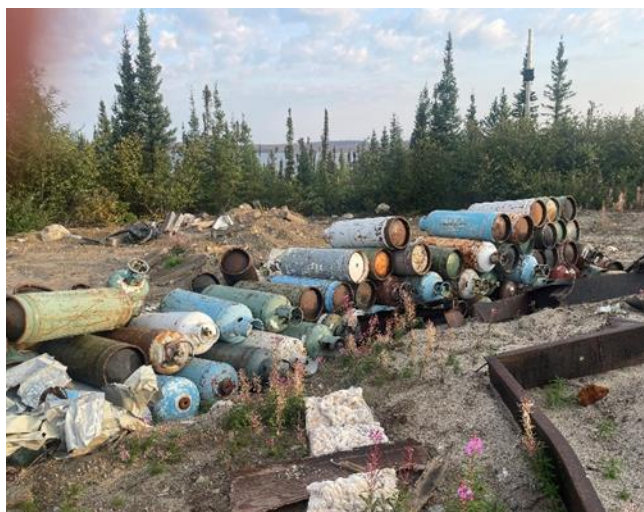
Photo 104 : Vue des bonbonnes de propane vidangées (valves retirées) prêtes pour le broyage (4 septembre 2023).
