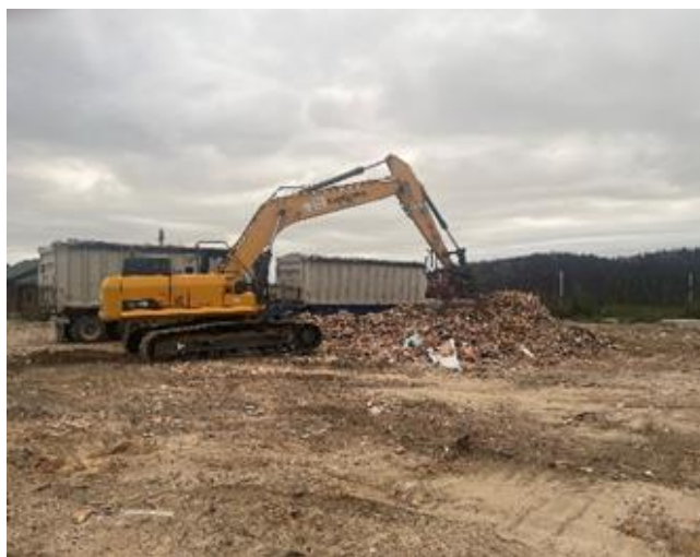
Photo 92 : Excavatrice LuiGong 925-E équipée d'un grappier.
