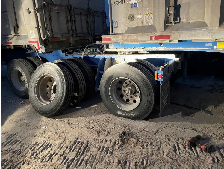
Photo #1 : Réparation crevaisson remorque #2
