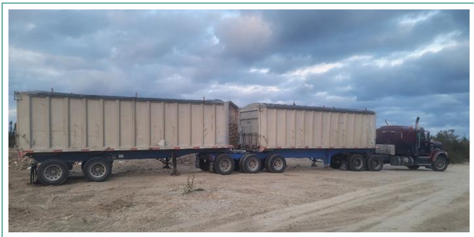
Photo 96 : Train double de type B avec bennes d'une capacité de 45 m 3 chacune.
