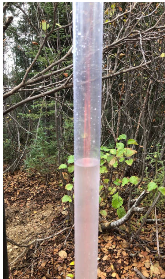
Photo 4 : Vue de l'eau retiré du puit F-23-15 lors d'une vérification de la possible présence d'une phase libre à cet endroit.
