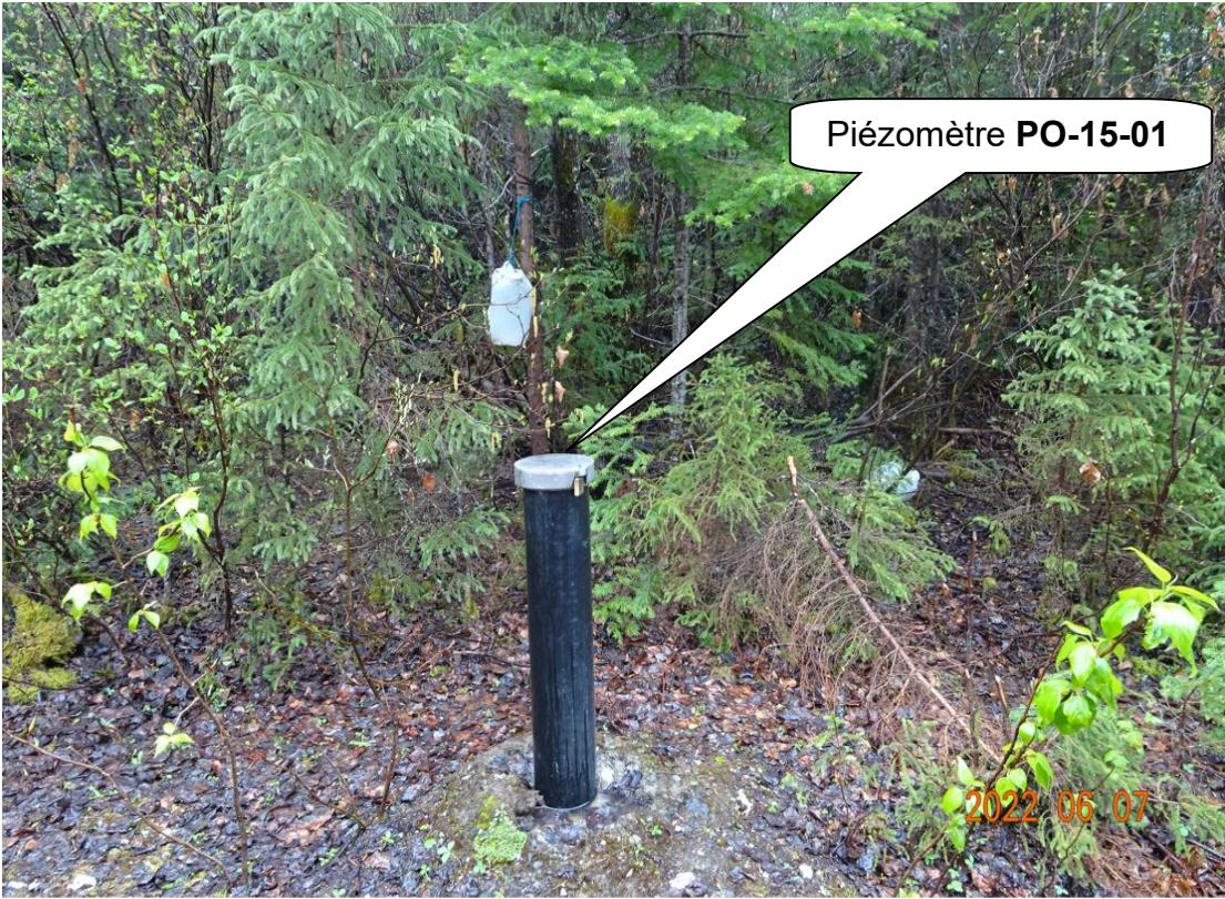
IS-2022-06-07-004 - Piézomètre PO-15-01 en très bon état (vue vers le Sud-Ouest) Coordonnées UTM Nad83 : 585340 Est, 5566344 Nord
