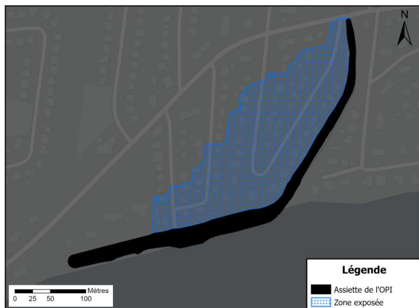
Figure 84 Polygone de la zone exposée délimitée à partir d'une élévation de 10,4 m.
