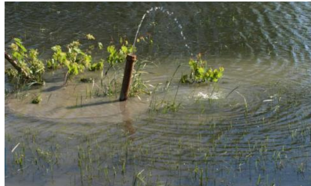
Figure 62 Transport de particules, par le biais d'une installation piézométrique endommagée, lors d'une inondation.
