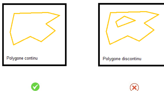
Figure 6.7 : Exemples d'un polygone continu et discontinu associés à une ZPRR
