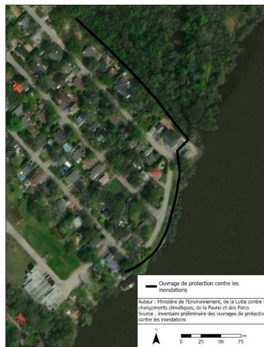
Figure 4 : Représentation linéaire d'un ouvrage continu comportant au moins un tronçon parallèle au cours d'eau ainsi qu'un autre tronçon perpendiculaire visant à compléter la protection (source : MELCCFP)
