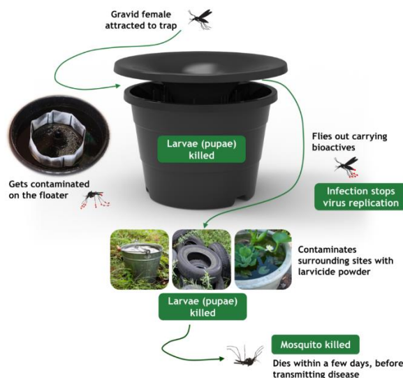
Figure 6. Fonctionnement du piège In2Care 468 .
