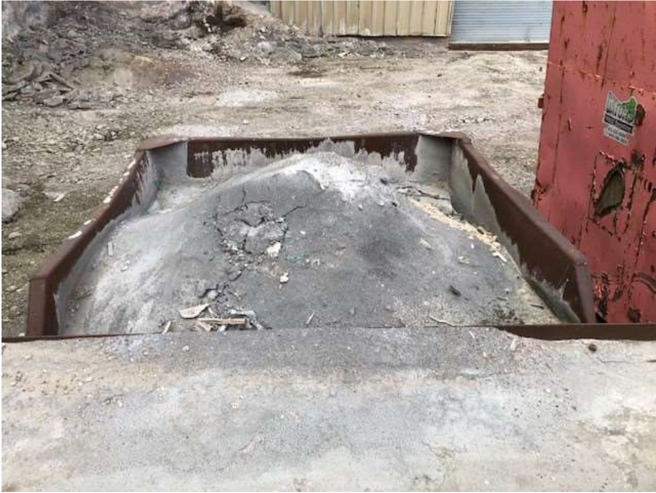
Figure 21 : Conteneur 10 verges - Récupération poudre et particules fines
