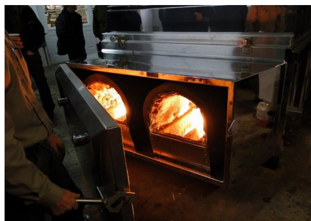
Biocarburants – Évaporateur acéricole alimenté par des granules de biomasse agricole - Source : Coopérative AgroÉnergie de l'Est
