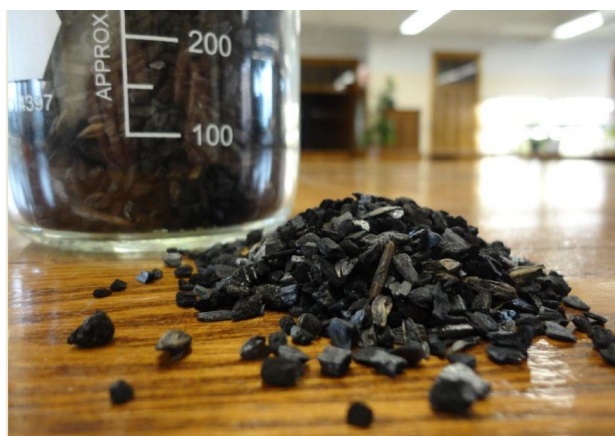
Biocarburants – Biochar, l'un des 3 co-produit de la pyrolyse de biomasse végétale (biochar, biohuile, biogaz chaud) - Source : Biopterre – Centre de développement des bioproduits
