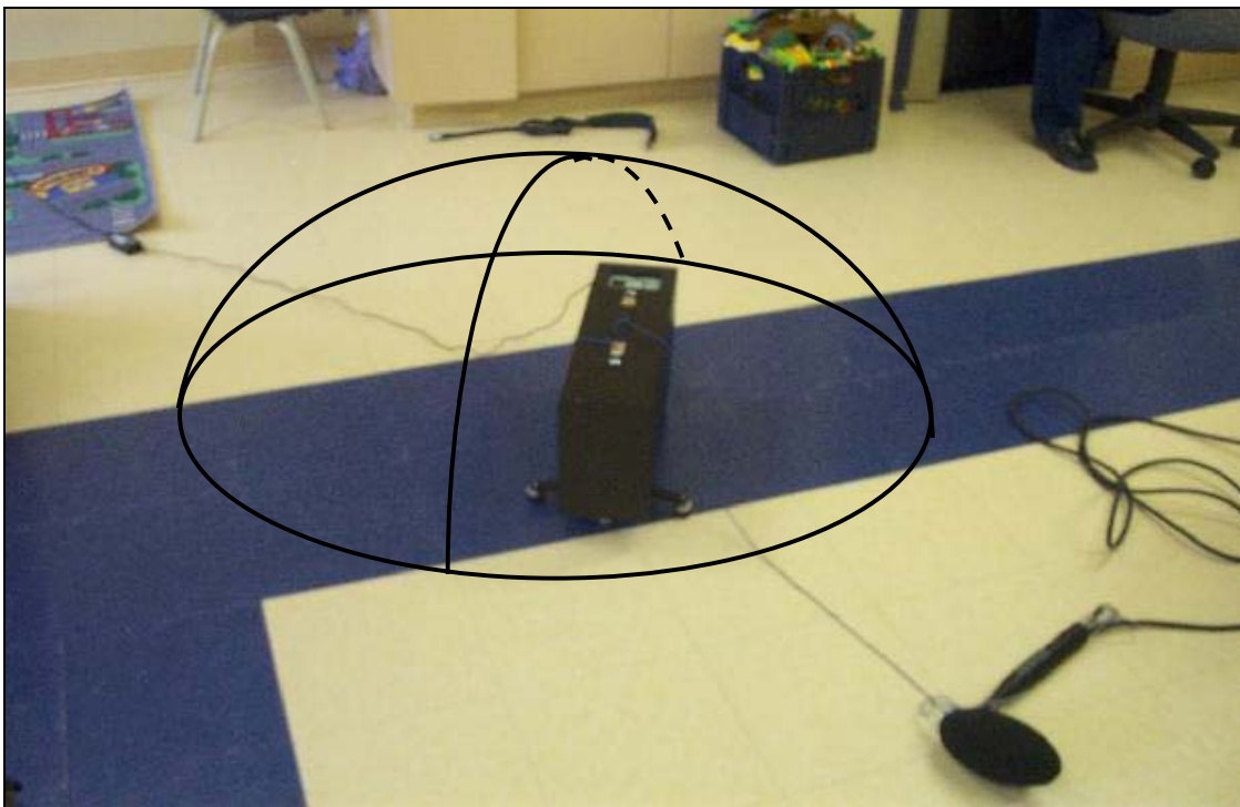
Figure 5 Machine à impacts avec la sonde acoustique utilisée pour les mesures d'intensimétrie (local 2 du CPE A)
