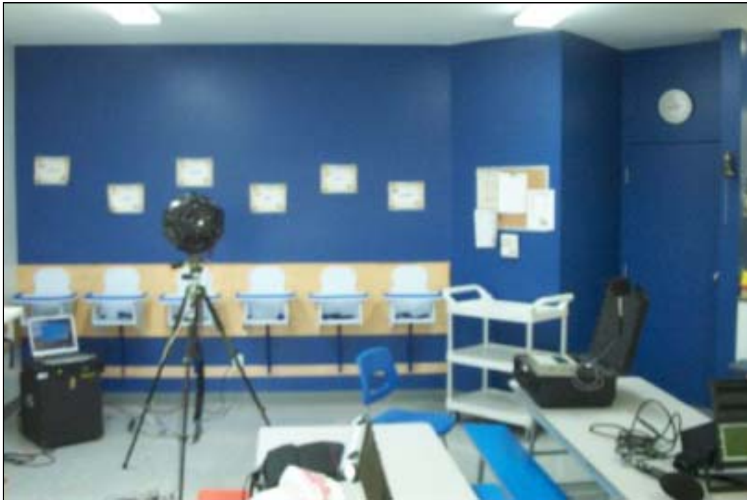
Figure 4 Source de bruit sphérique servant à la mesure du temps de réverbération local 1 du CPE C)
