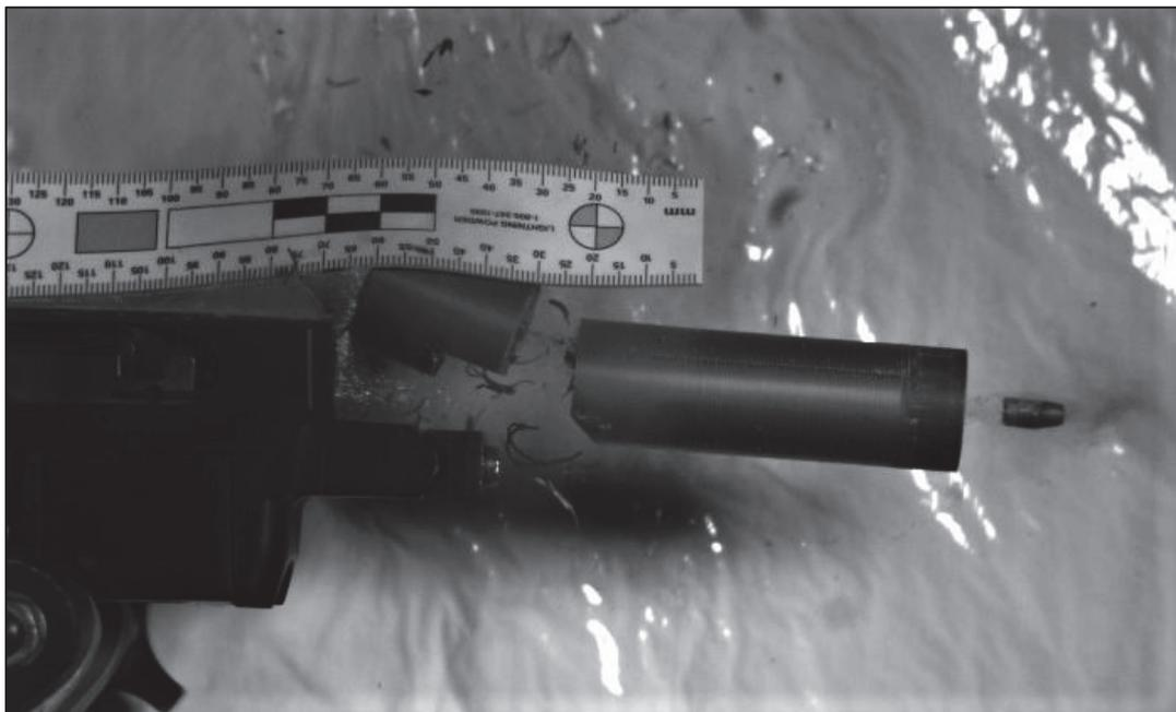
Figure 3.22 Bris du canon en ABS lors du tir expérimental
