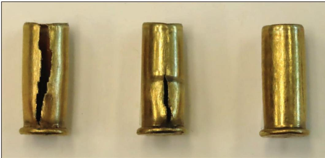
Figure 3.26 Douilles restées coincées dans la chambre à la suite de la décharge. De gauche vers la droite, il est possible d'observer une douille gonflée et fendue, gonflée et partiellement fendue, puis légèrement gonflée
