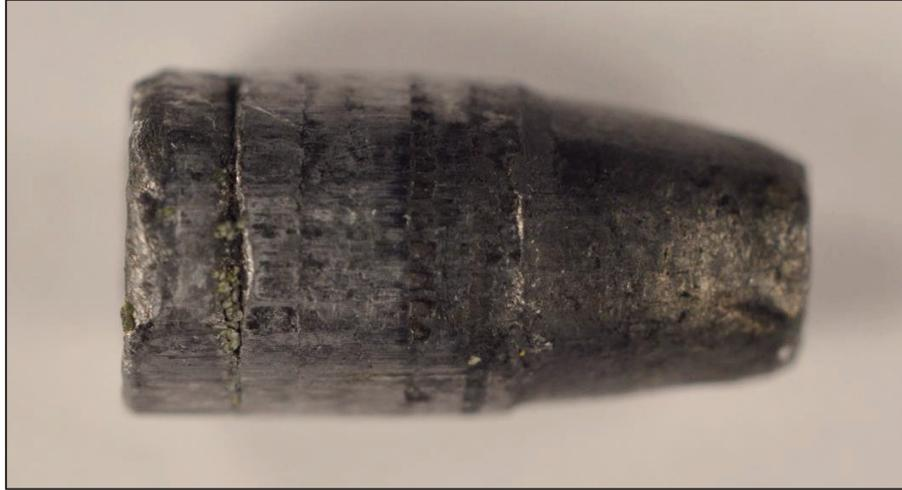
Figure 3.28 Projectile récupéré au sol à la suite des tirs expérimentaux effectués avec les armes à feu hybrides imprimées en 3D
