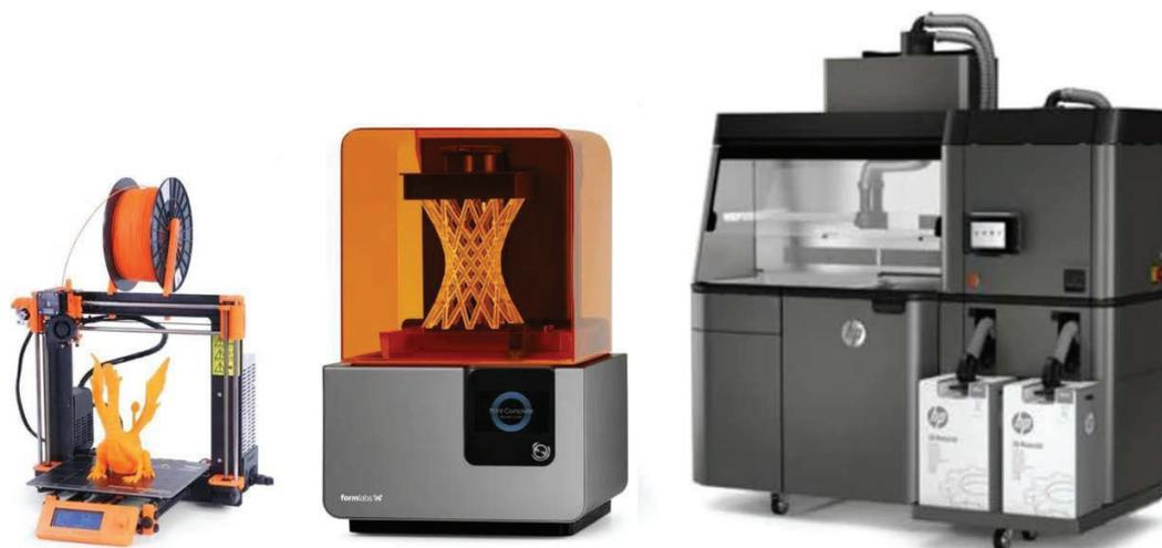
Figure 1.8 Différents types et catégories d'imprimantes 3D, allant de l'imprimante personnelle, professionnelle à industrielle, images tirées de (ALL3DP, 2020b)
