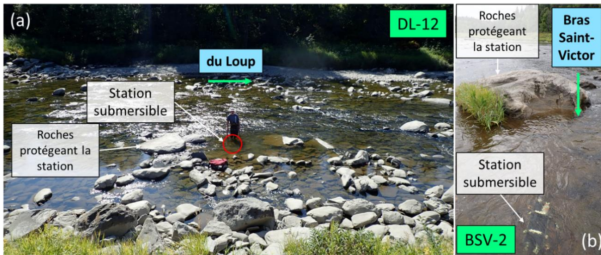
Figure 13. Installation des instruments dans le bassin versant de la CH pour l'hiver 2019-2020 : (a) station submersible au site DL-12; et (b) station submersible au site BSV-2. Les flèches vertes indiquent le sens de l'écoulement.
