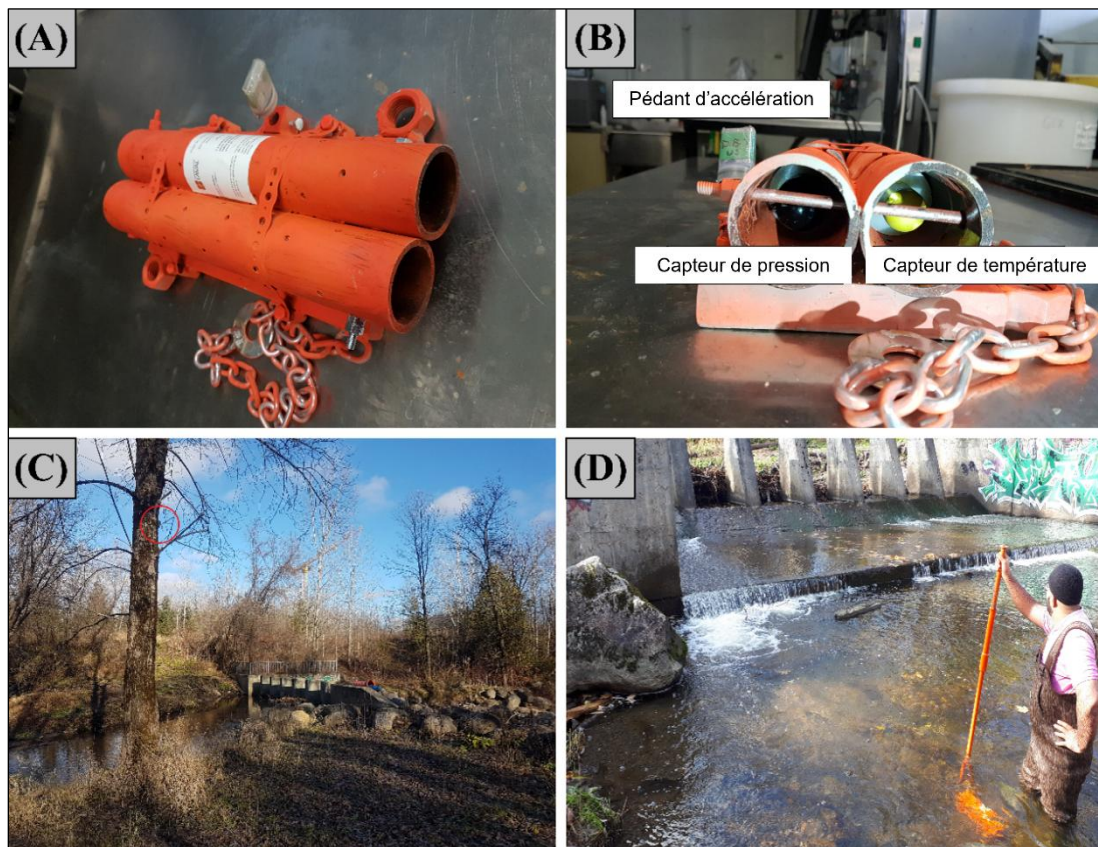
Figure 4. (a) plateformes submersibles installées aux cinq sites; (b) détails de la plateforme (c) emplacement de la caméra et (d) de la plateforme sur le site Du-Berger.
