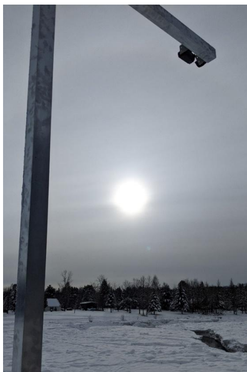
Figure 13. Caméras horizontales dirigées vers le couvert de glace en aval du barrage de Saint-Raymond (photo prise par A. Pierre le 22 décembre 2022).
