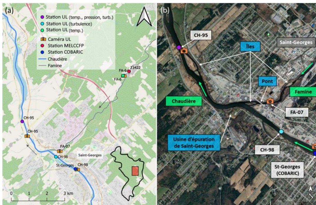
Figure 9. Sites étudiés lors de la débâcle 2020 à la confluence FA : (a) vue d'ensemble des sites et (b) image satellite de la confluence. Les flèches grises et vertes indiquent le sens de l'écoulement.
