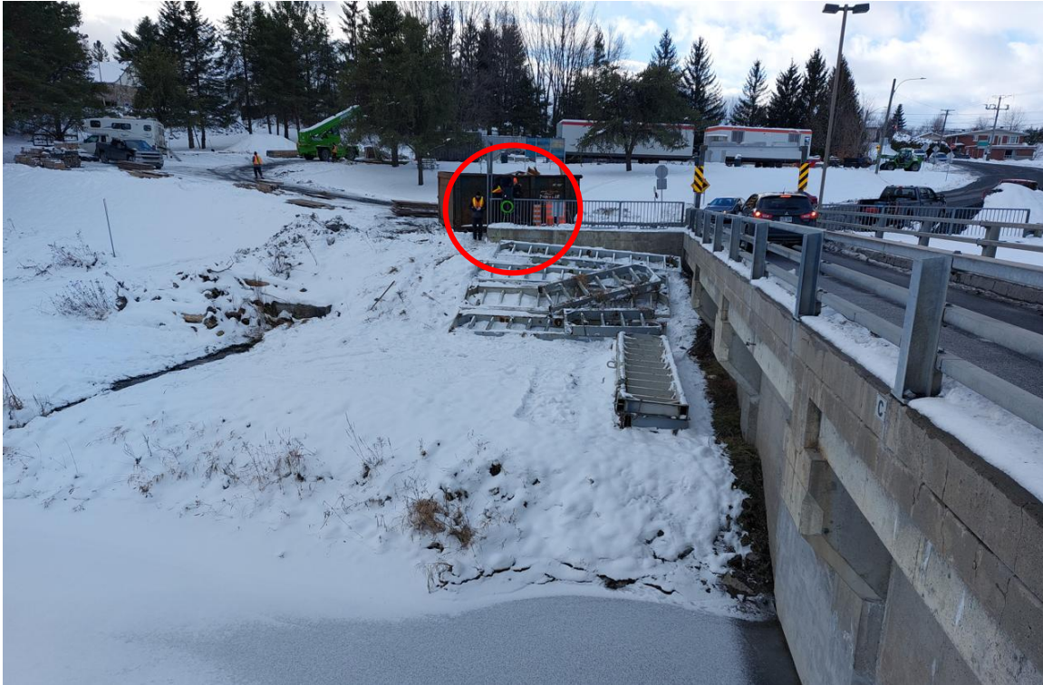
Figure 6. Emplacement du mini-ordinateur enregistrant les données de l'ADCP sur la rive gauche de la rivière Chaudière (photo prise par H. Pourshahbaz le 26 décembre 2022).
