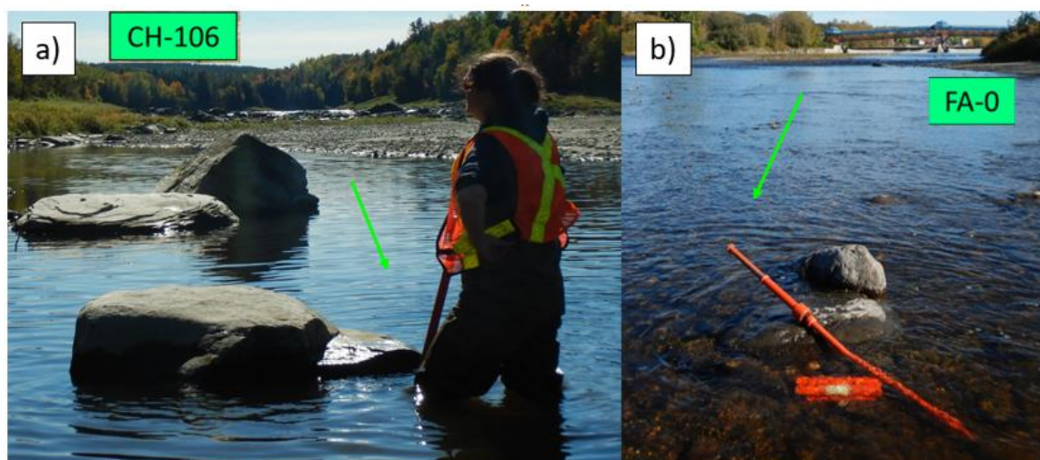
Figure 37. Installation des instruments dans le bassin versant de la rivière CH pour l'hiver 2022-2023 : (a) emplacement de la station submersible au site CH-106 et (b) station submersible au site FA-0. Les flèches vertes indiquent le sens de l'écoulement.
