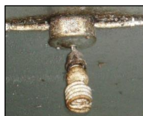
Non-conformité : Détérioration de douilles de type Temporary use only
