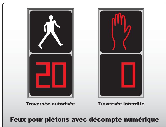
Figure 10-1 Feux pour piétons
