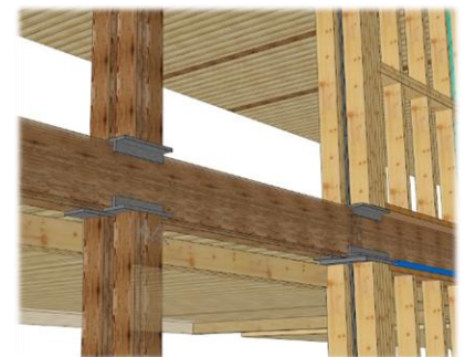
Figure 4 - renfort plaques en T
