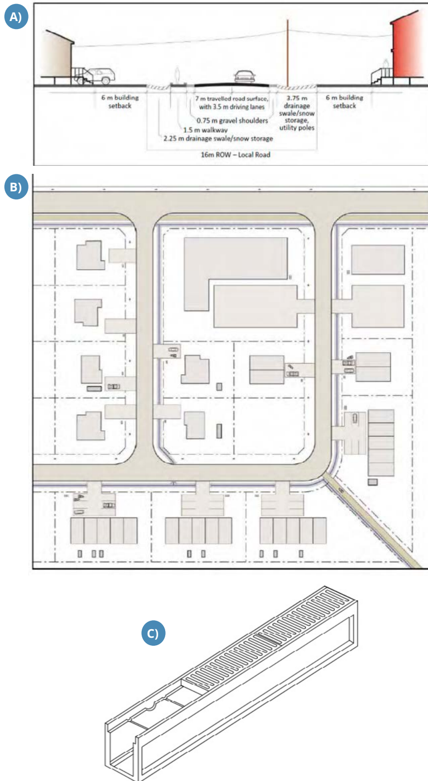
FIGURE 5.90 : A) VUE DE PROFIL ET EN PLAN ILLUSTRANT LA CONFIGURATION OPTIMALE D'UN RÉSEAU DE DRAINAGE SOIGNEUSEMENT INTÉGRÉ À LA CONFIGURATION URBAINE D'UNE COMMUNAUTÉ (TIRÉ DE CAN/CSA-S503-15, « COMMUNITY DRAINAGE SYSTEM PLANNING, DESIGN, AND MAINTENANCE IN NORTHERN COMMUNITIES », 2015 NBR P. 83, CODE DE PRODUIT : 2423574). B) CANIVEAU PEU PROFOND EN BÉTON RECOUVERT D'UNE GRILLE, UTILISÉ AVEC SUCCÈS AU NUNAVIK AUX INTERSECTIONS DES RUES.
