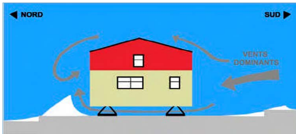
FIGURE 3.3 : AÉRODYNAMISME DES MAISONS POUR RÉDUIRE L'ACCUMULATION DE NEIGE SOURCE : CENTRE D'ÉTUDES NORDIQUES, UNIVERSITÉ LAVAL
