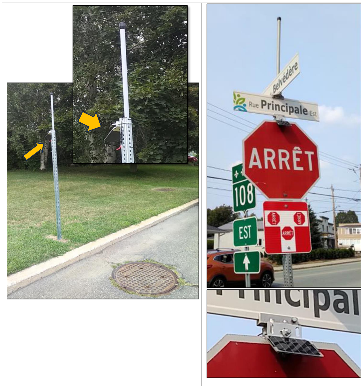
Figure 6-25. Exemples d'installation avec panneau solaire. Des panneaux de faibles dimensions peuvent suffire. GAUCHE : utilisation d'un mât hors-chaussée pour supporter une antenne et un panneau solaire. L'enregistreur est situé dans le regard sur cette photo (mais il aurait pu aussi être installé sur le mat). DROITE : Panneau solaire et antenne installés sur un poteau d'utilité publique. En raison de l'orientation sud, le panneau solaire a été placé sur le devant de la signalisation (et non à l'arrière), en prenant toutefois soin de maintenir la visibilité de cette dernière.
