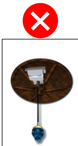
Figure 6-23. L'installation d'un équipement directement sous un couvercle de regard comme indiqué ci-contre devrait être évitée car elle est propice à endommager l'équipement lors du soulèvement du regard.
