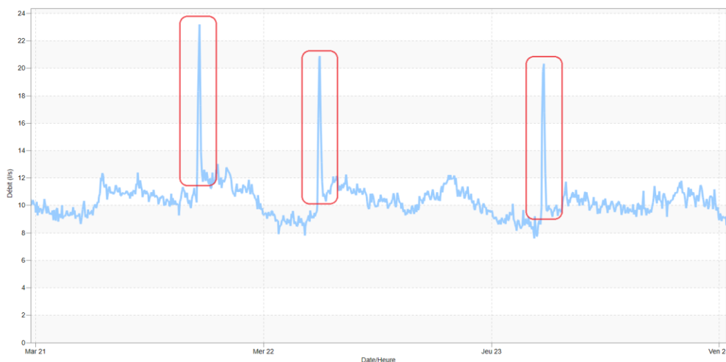
Figure 10-9. Pointes de débits réguliers signalant de possibles rejets industriels
