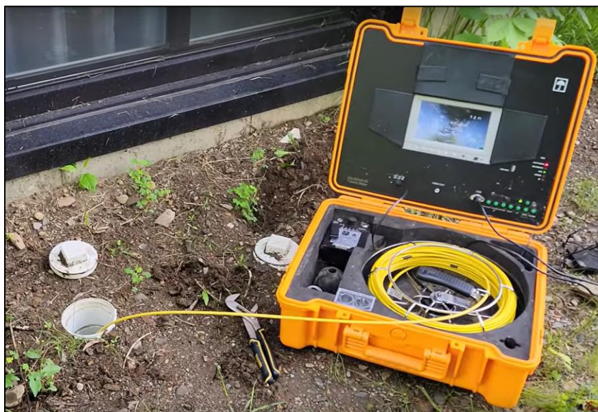
Figure 11-1. Exemple de caméra par insertion
