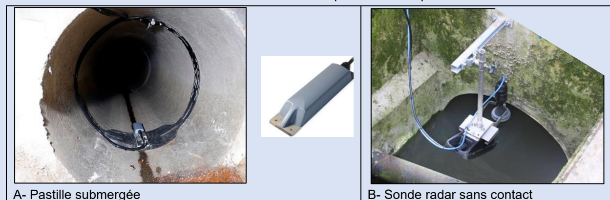
Figure 13-2. Exemples d'appareils permettant de mesurer des débits
