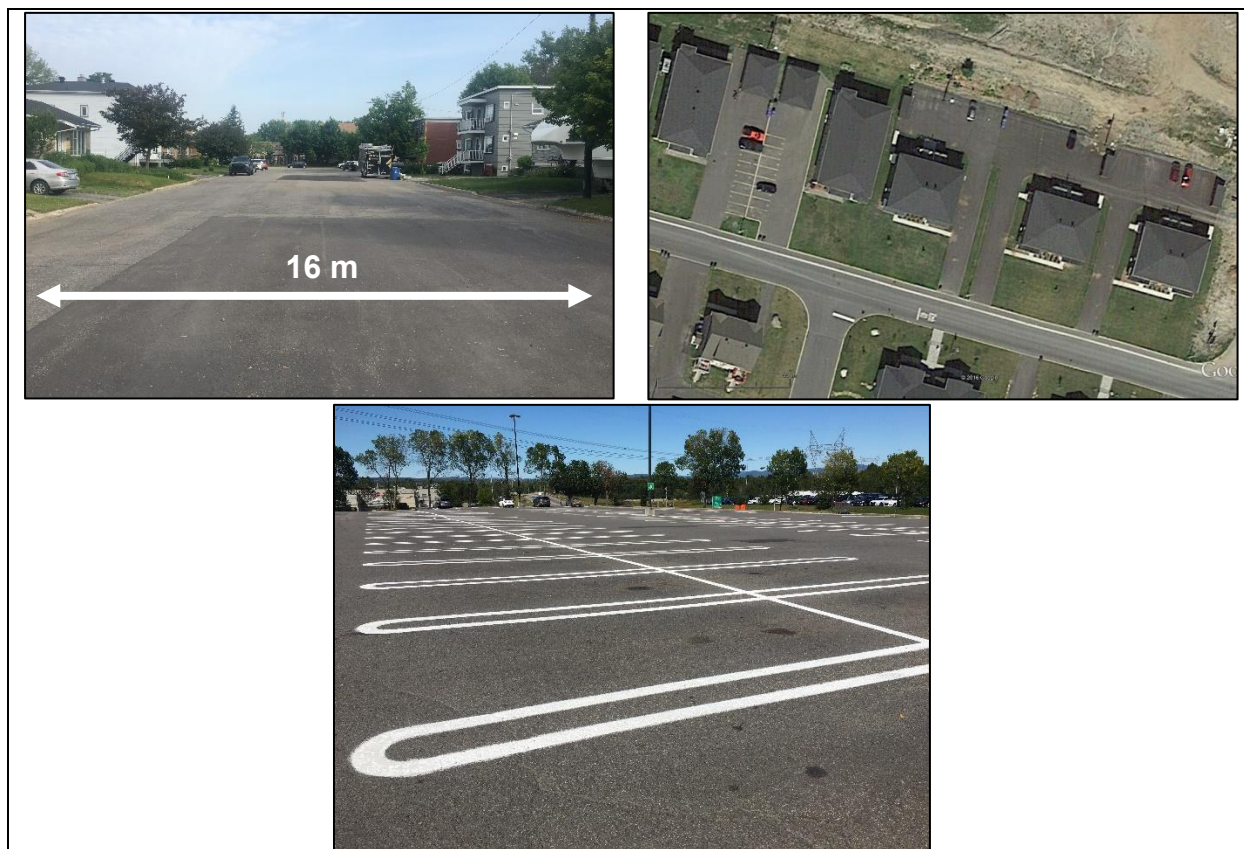
Figure 19-1 Exemples québécois d'occupation du territoire favorisant le ruissellement et les débordements lorsque le drainage est assuré en partie par un réseau unitaire. Gauche : rue sans issu (cul-de-sac) d'un quartier résidentiel, peu arborée et surdimensionnée (largeur de 16 m, comparativement à 8 à 10 m typiquement pour une rue de fonction équivalente). Droite : exemple d'un projet domiciliaire générant beaucoup d'eaux de ruissellement : grandes marges de recul avant (obligeant de longues allées asphaltées), présence d'allées en parallèle (plutôt que communes) doublant les surfaces imperméables, absence d'arbres, absence de revêtement perméable, absence d'aménagement pour infiltrer les eaux pluviales, gouttière évacuant les eaux vers la rue. Bas : stationnement dont l'aménagement favorise le ruissellement. En plus de diriger les eaux pluviales à l'égout plutôt que vers des infrastructures d'infiltration (infrastructures vertes), la largeur des cases de stationnement est d'environ 3 m plutôt qu'une largeur de 2,5 m généralement reconnue comme suffisante. Par conséquent, les cases de stationnement génèrent environ 20 % plus d'eaux pluviales que celles d'un autre stationnement de même capacité, soit autant d'eau additionnelle devant être gérée par la municipalité et susceptible de provoquer des débordements si elles sont captées par un égout unitaire.
