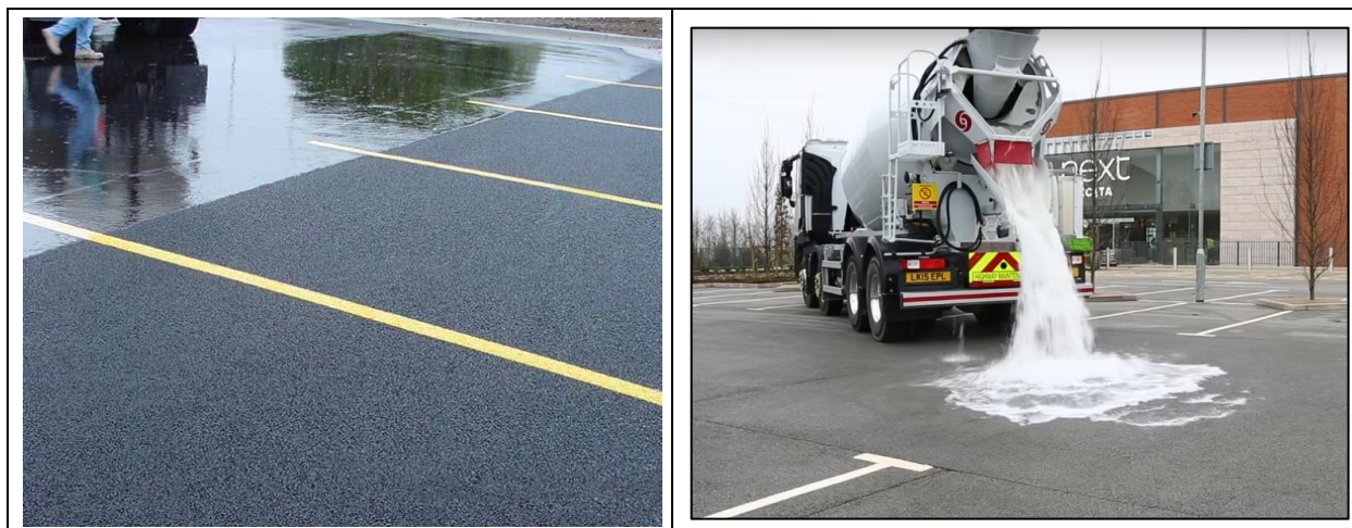
Figure 19-20. Démonstration des propriétés drainantes de l'asphalte poreux
