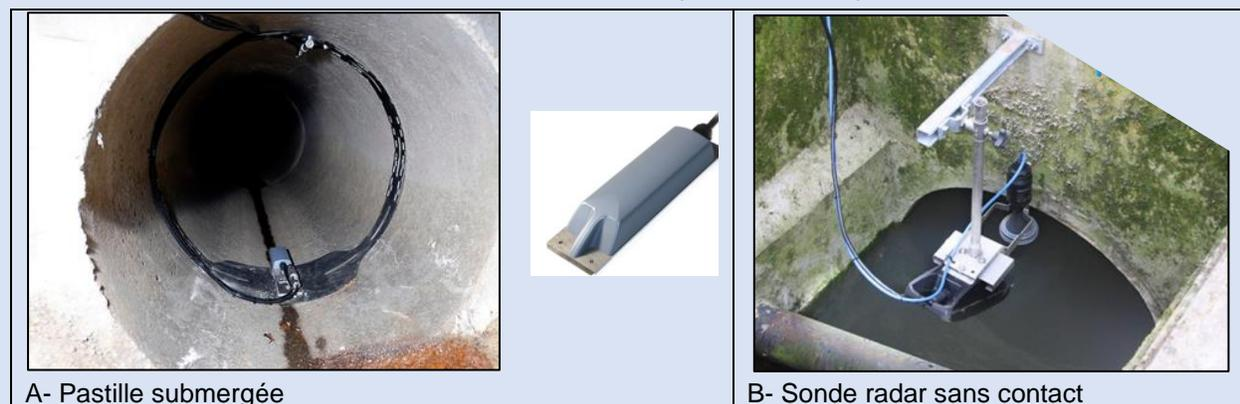
**Figure 13-2.** Exemples d'appareils permettant de mesurer des débits
