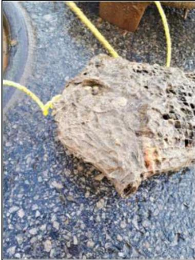
**Figure 11-5.** Exemple d'utilisation d'une grille au fond d'un regard d'un système de gestion d'eaux pluviales pour détecter la présence d'un raccordement inversé
