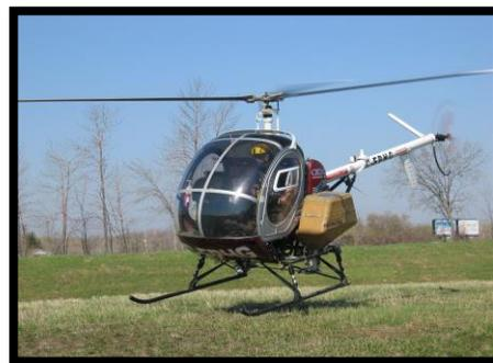
**Figure 5.11 Hélicoptère équipé d'un épandeur de pesticide granulaire**
