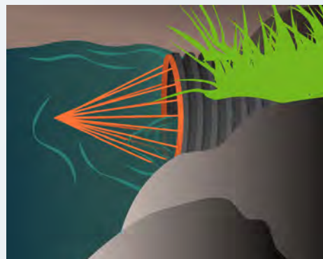
Grillage limitant l'accès du castor à un passage de rainette
