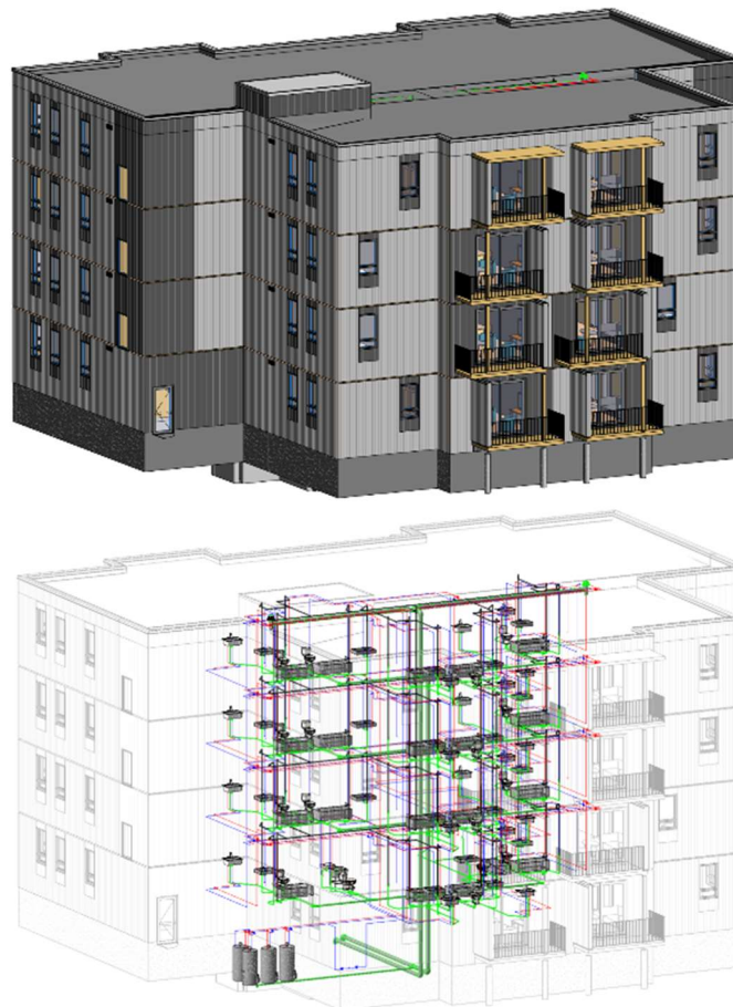
Figure 9 Vues du bâtiment « fini », en haut, et des éléments de plomberie (en bas)
