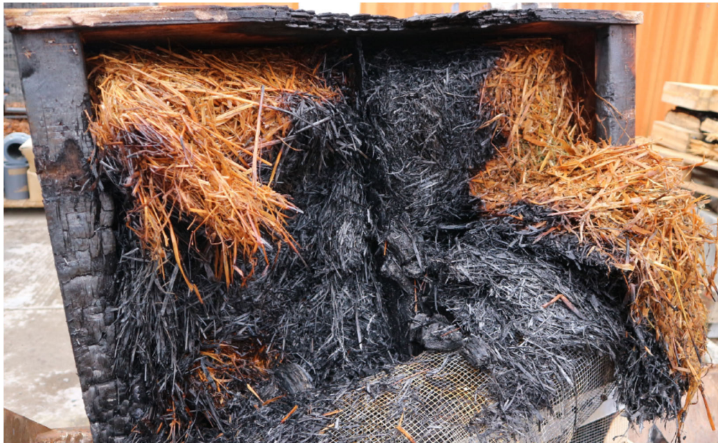
Figure 13 : État de l'échantillon après l'essai de résistance au feu
