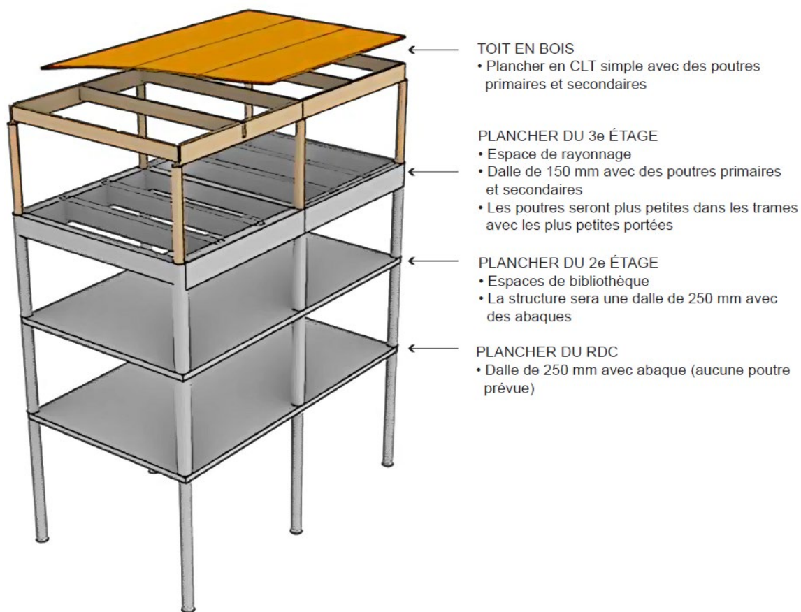
Figure 3 : Schéma conceptuel du système structural élaboré à l'étape du concours architectural
