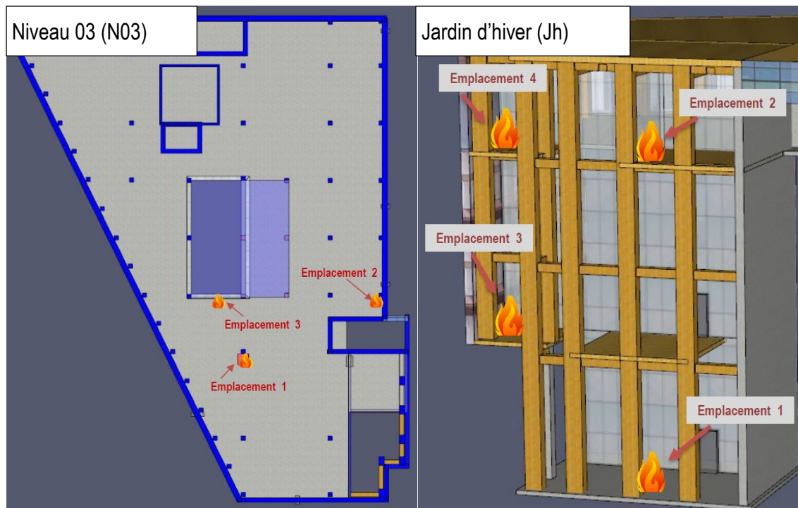
Figure 5 : Emplacement des foyers d'incendie simulés
