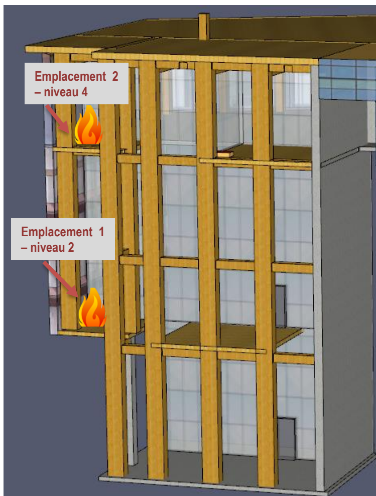
Figure 9. Deux (2) emplacements du foyer d'incendie (feu de sapin)
