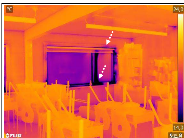
T-116: ( \Delta P -) Infiltration d'air au périmètre de la fenestration; Mouvement d'air au volet ouvrant
