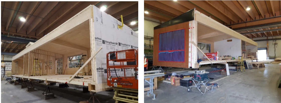
Figure 3 : Différentes étapes de fabrication. À gauche, la structure. À droite, la finition extérieure et intérieure.
