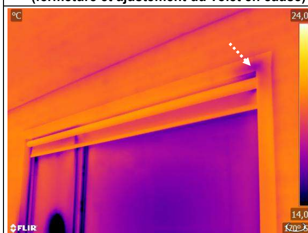
T-106: ( \Delta P -) Infiltration d'air au périmètre de la fenestration;
