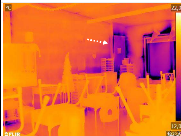
T-59: (ΔP-) Vue générale classe P; Mouvement d'air important au coin du mur et dans le panneau inséré au mur
