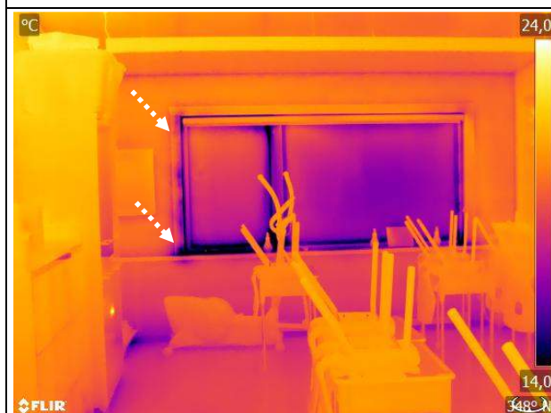
T-114: ( \Delta P -) Infiltration d'air au périmètre de la fenestration;
