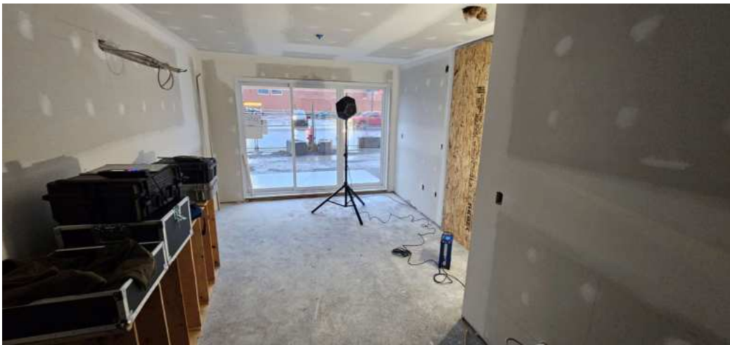
Photo 2 : Mesure de la réverbération dans l'unité 101
