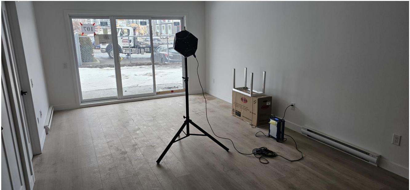
Photo 1 – Source omnidirectionnelle dans le salon de l’unité #107.
