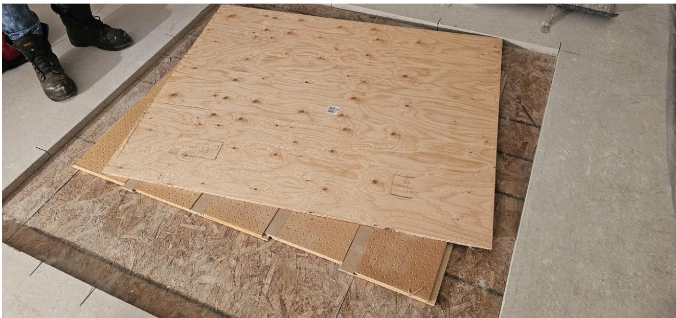
Photo 2 : Assemblage Sonomax 25 + Contreplaqué
