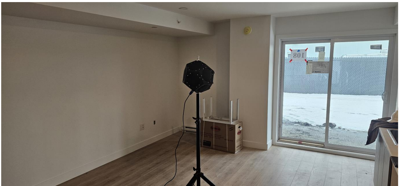
Photo 2 – Étude de réverbération dans l’unité 108.
