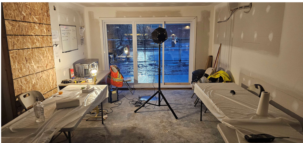
Photo 3 : Mesure de la réverbération dans l'unité 102
