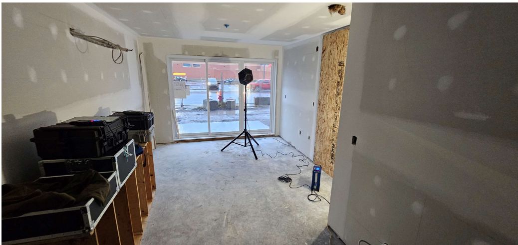
Photo 2 : Mesure de la réverbération dans l'unité 101
