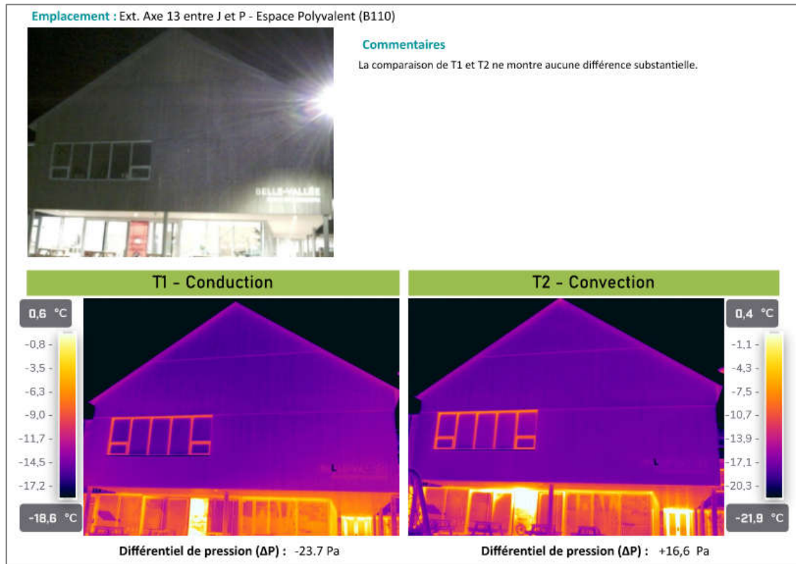
Figure 17 : Résultat de la thermographie – installation du seuil de porte corrigée par l'entrepreneur à la suite de cette analyse
