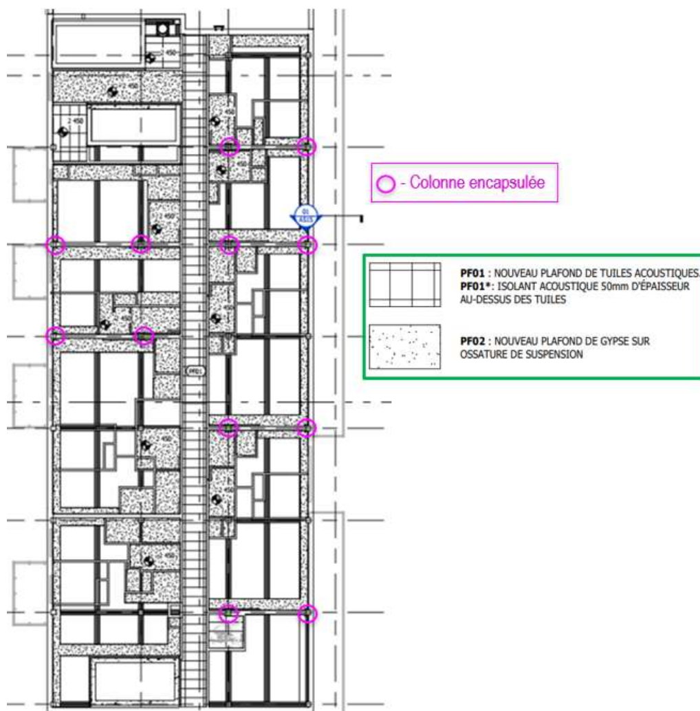
Figure 5 : Revêtement du plafond et colonnes encapsulées : tour droite
