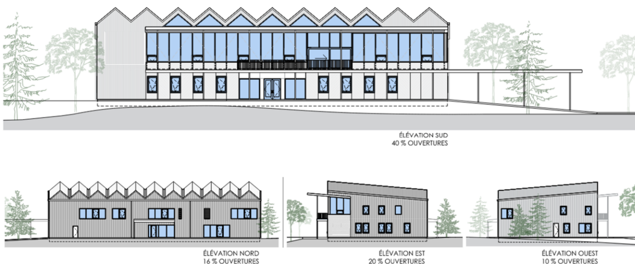
Élévations montrant le pourcentage d'ouvertures selon l'orientation
